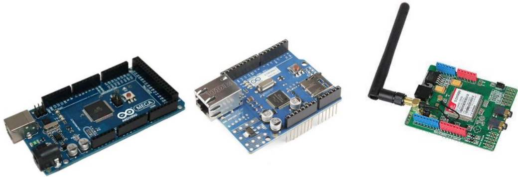
Figura 31 Arduino MEGA 2560 y sus módulos.
