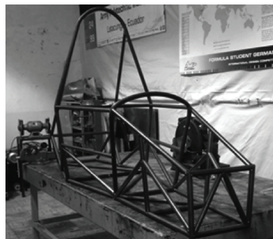
Figura 5: Bastidor construido. Fuente: Los autores.
