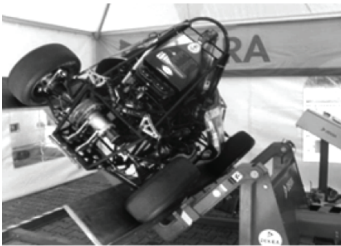
Figura 10: Prueba de vuelco a 60 grados. Fuente: Los autores.
