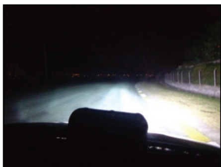
Fig 6: Iluminación en curva a la derecha con sistema inteligente
