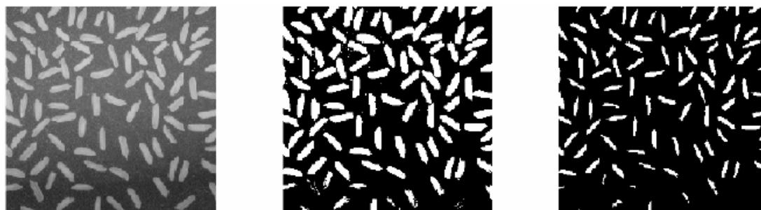
**Figura 2.6** Ejemplo de proceso de erosión binaria [10]
