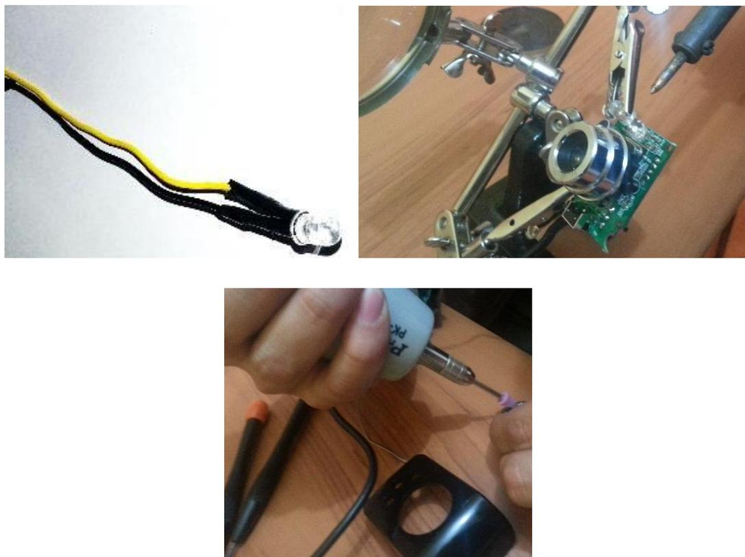
**Figura 3.10** Acoplamiento del Diodo LED a la cámara
