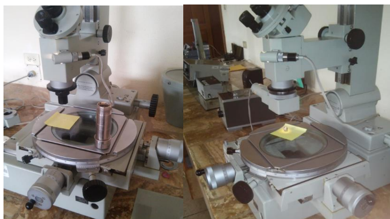
Figura 119. Microscopio para la medición de granulometría de muestras
