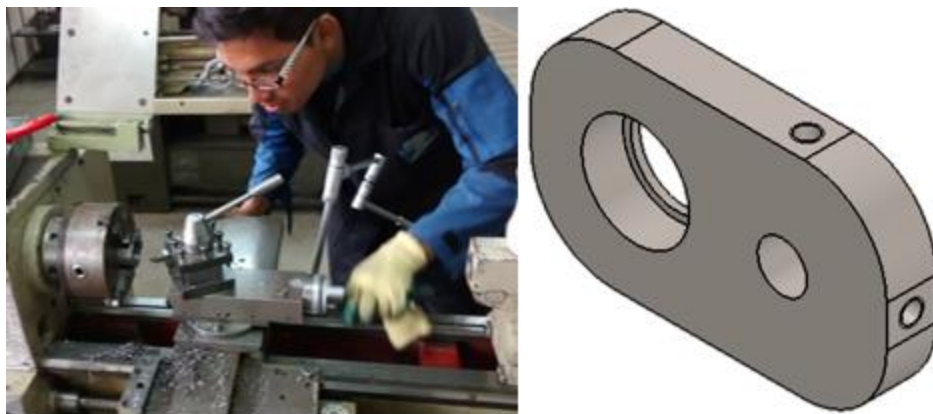
Figura 103. Proceso de mecanización de eslabón manivela
