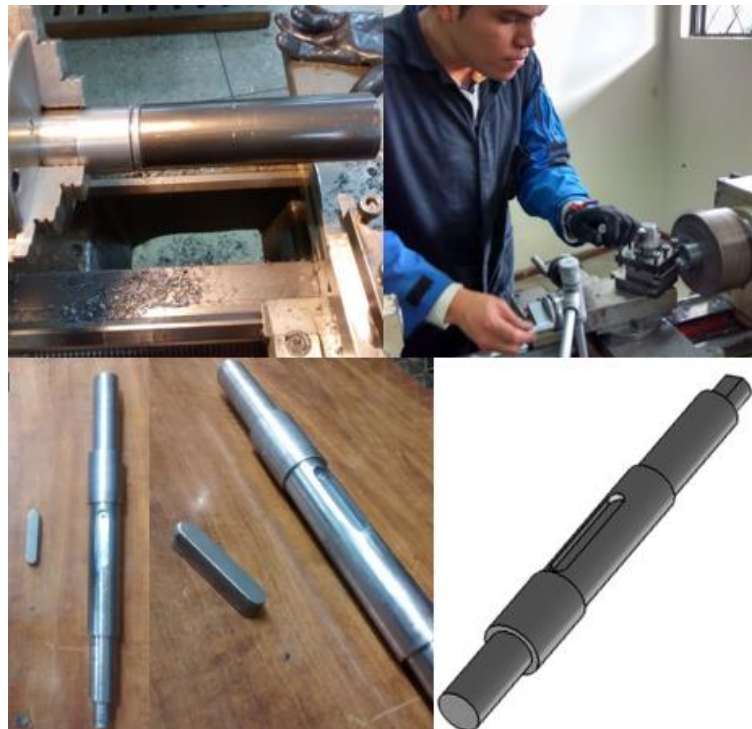
Figura 102. Proceso de mecanización de eje
