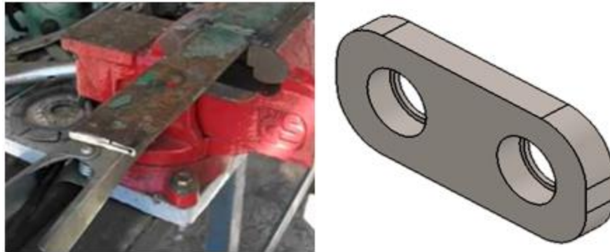
Figura 104. Proceso de mecanización de eslabón acoplador
