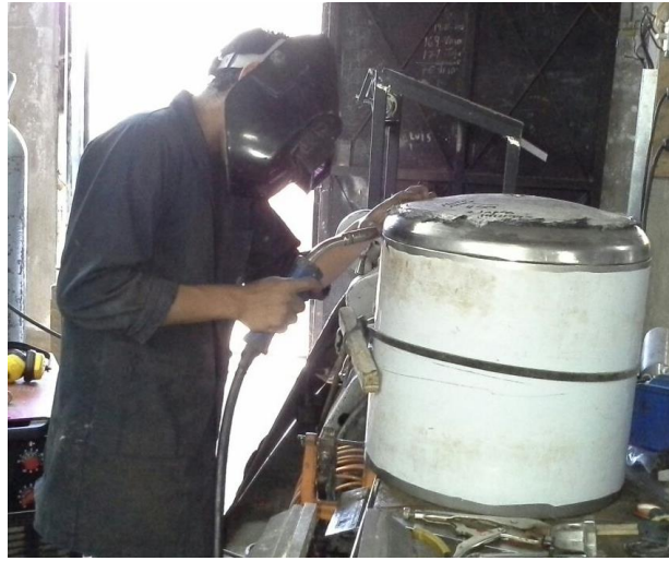
Figura 17: Soldadura de tapa toriesférica
