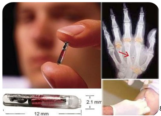
Figura 2. 8: Tag RFID de Implante Humano
