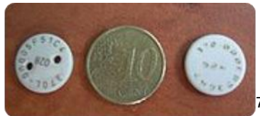
Figura 2. 7: Tag RFID para Empresas Textiles
