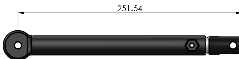
Figura 28: Longitud mínima de la barra de soporte del muslo
