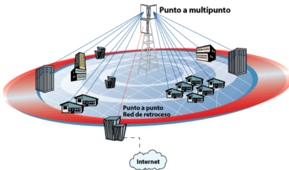
Figura 2.11: Estructura General de un WISP.
