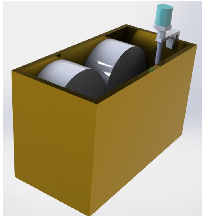
Figura 36 Esquema 3D de propuesta de instalación de sensor de temperatura.
