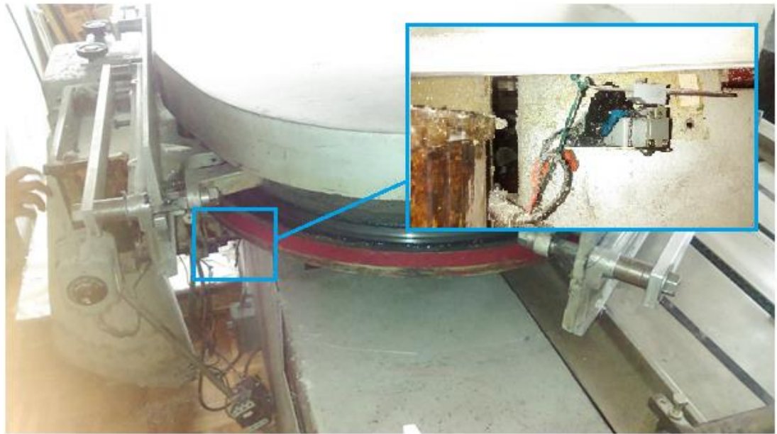
Figura 30 Ubicación del motor principal de la máquina encoladora
