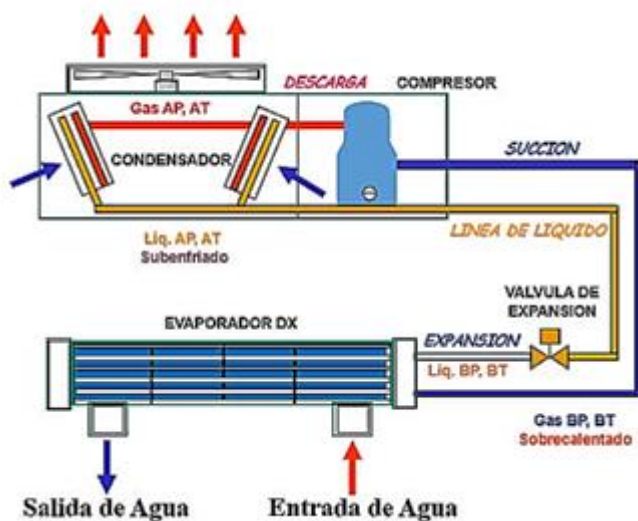
Figura 37. Composición de un enfriador de agua.
