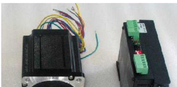
Figura 80. Motor NEMA 34 a su controlador (driver).
