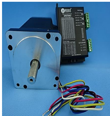
Figura 81. Motor NEMA 23 a su controlador (driver).
