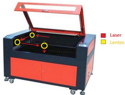
Figura 4. Ilustración Sistema de reflexión láser.
