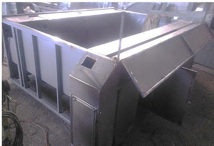
Figura 56. Armazón ensamblado de la mesa tipo pórtico.
