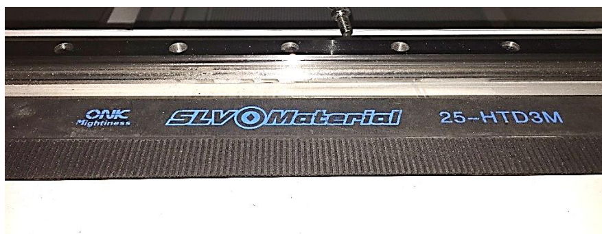
Figura 73. Banda implementada a lo largo del eje Y.
