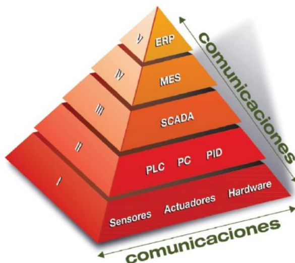
Figura 3. Pirámide de Automatización
