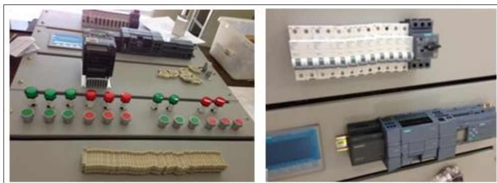
Figura 48. Distribución Física de los Elementos del Sistema
