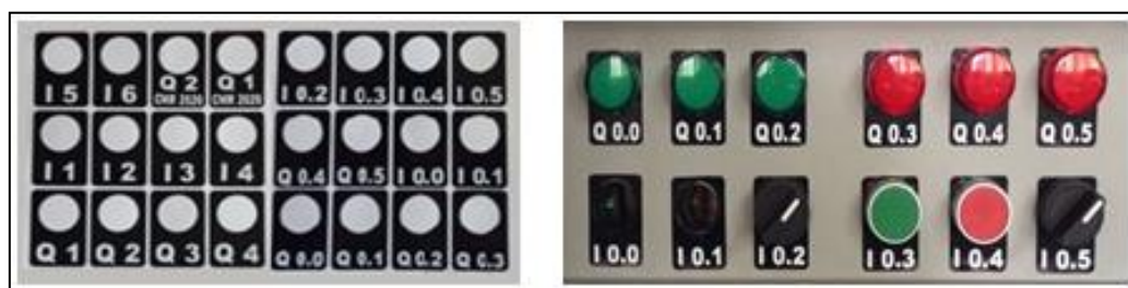
Figura 55. Etiquetas de señalización - Etiquetas implementadas
