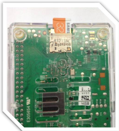
Figura 20. Colocación del micro SD en la ranura
