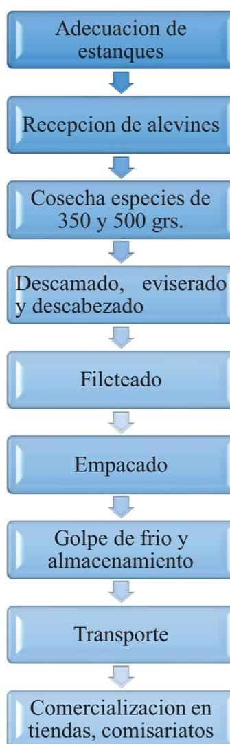
**Figura 68. Flujograma del proceso de Tilapia roja**
