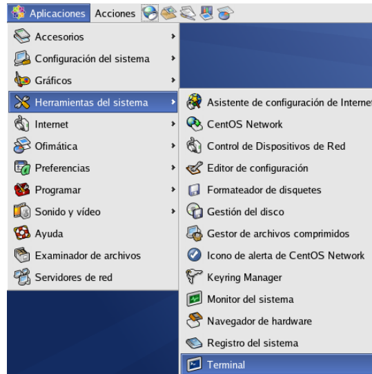
Figura 4-53: Ejecución de una ventana de Terminal
