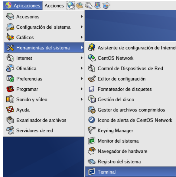
Figura 4-22: Ejecución de una ventana de Terminal
