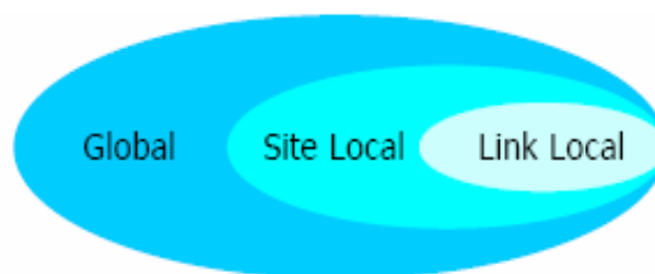
Figura 2-3: Clasificación de direcciones IPV6 según el alcance
