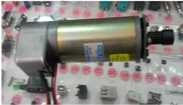
Figura 86. **Motor de corriente directa**
