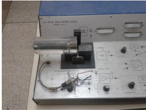
Figura 4 **Módulo 2 para el control de velocidad de motor DC**
