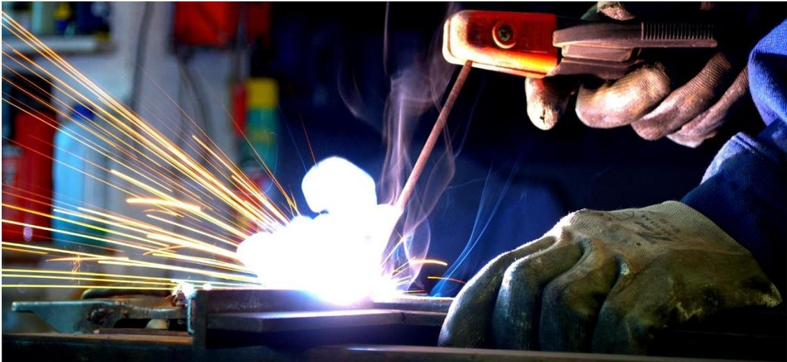
Figura 73. **Soldadura con electrodo**
