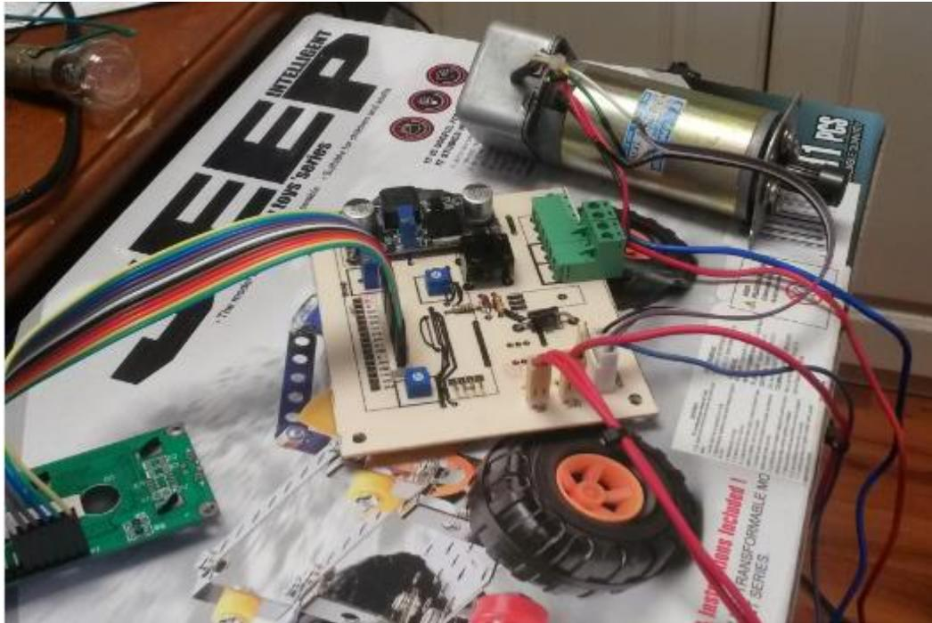
Figura 93. **Placa de circuito impreso para el control de velocidad**
