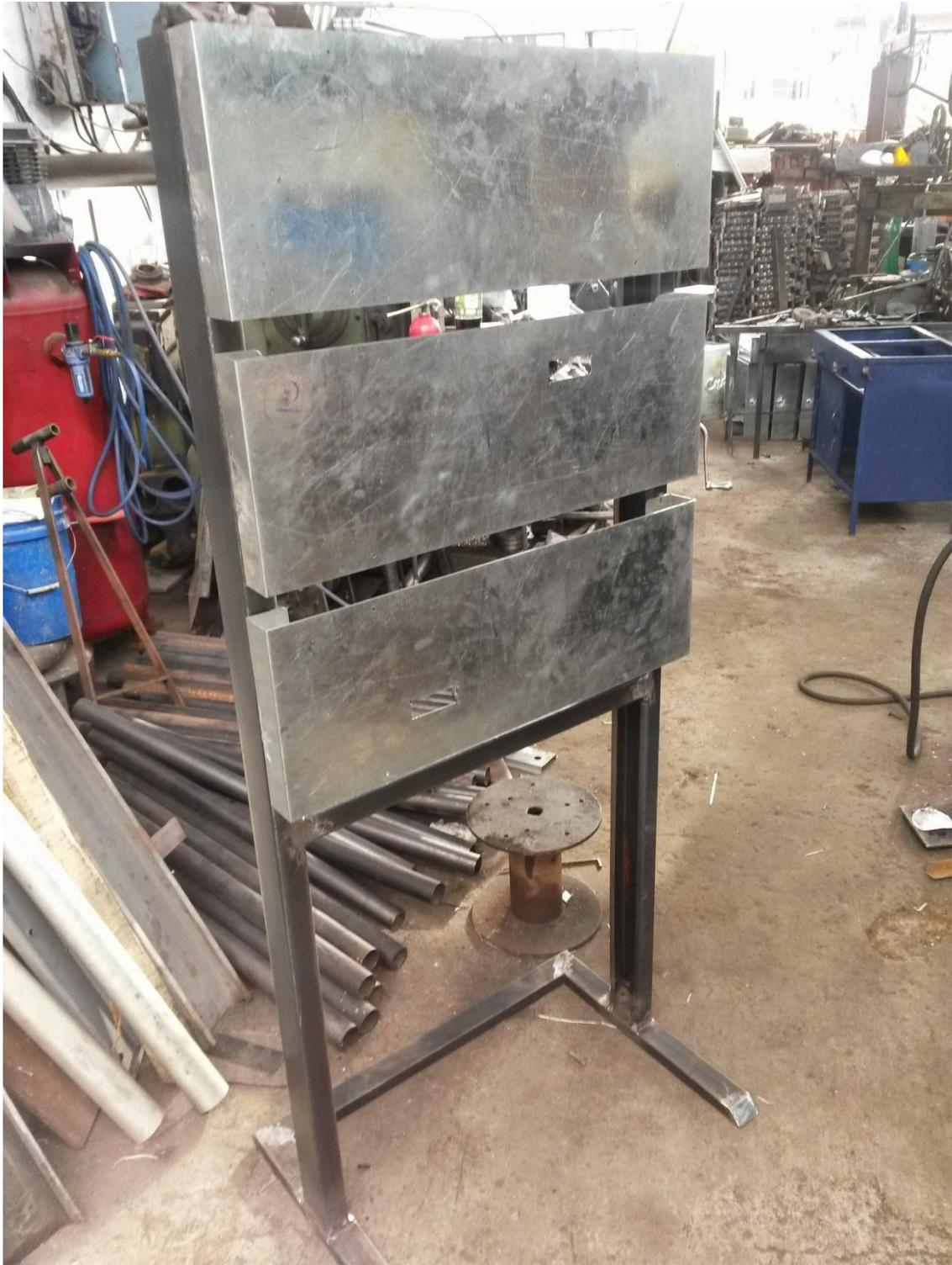
**Figura 74. Estructura soporte y módulos acoplados**
