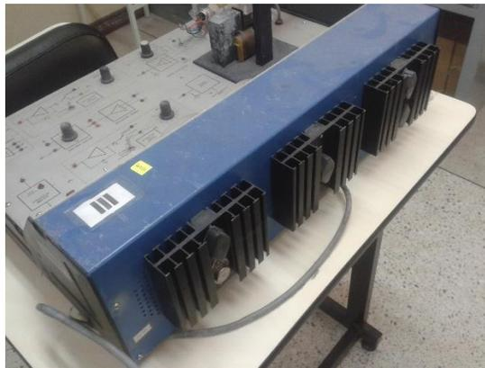
**Figura 3 Módulo 1 para control de velocidad de motor DC**
