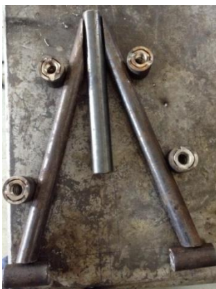
Figura 57 Colocación de tubos en el boceto del brazo
