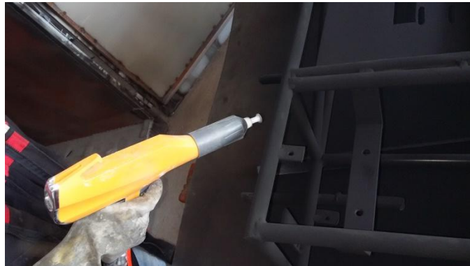
Figura 72 Aplicación de pintura en polvo
