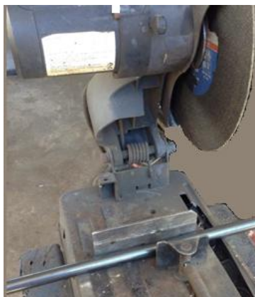
Figura 45 Corte de los tubos
