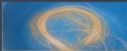
Preparación de muestras de fibra la cual consiste en el proceso de secado a una temperatura de 140°C durante un periodo de 15 minutos para reducir el porcentaje de humedad de la fibra natural de Abacá.
