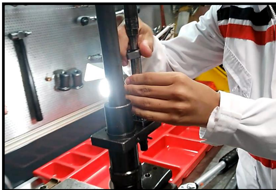
Figura 90. Ubicación del inyector (Denso) en la prensa
