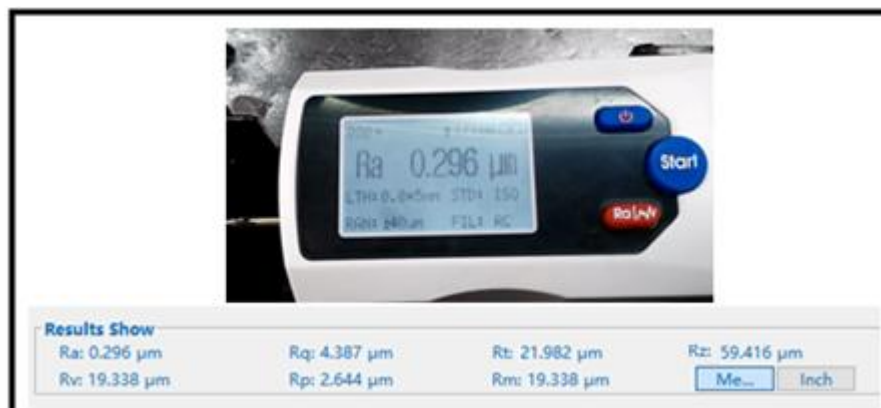
Figura 148. Mediciones de desgaste arrojados del rugosímetro - software
