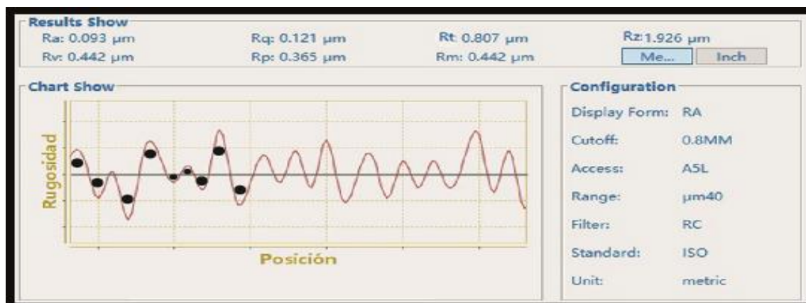
Figura 168. Rugosidad vástago de la aguja de Tobera inyector Denso
