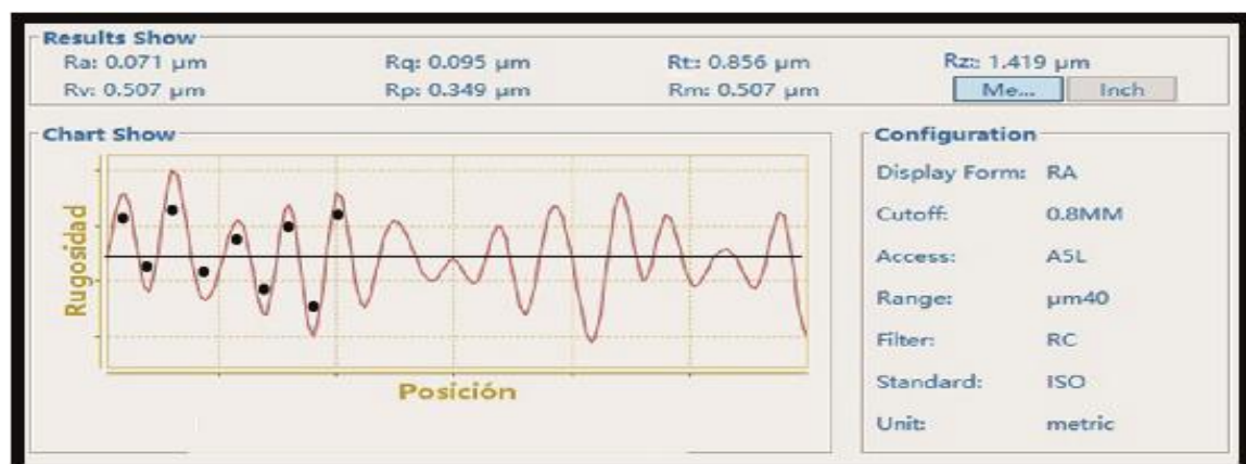
Figura 162. Rugosidad punta cónica de la aguja de Tobera inyector Bosch
