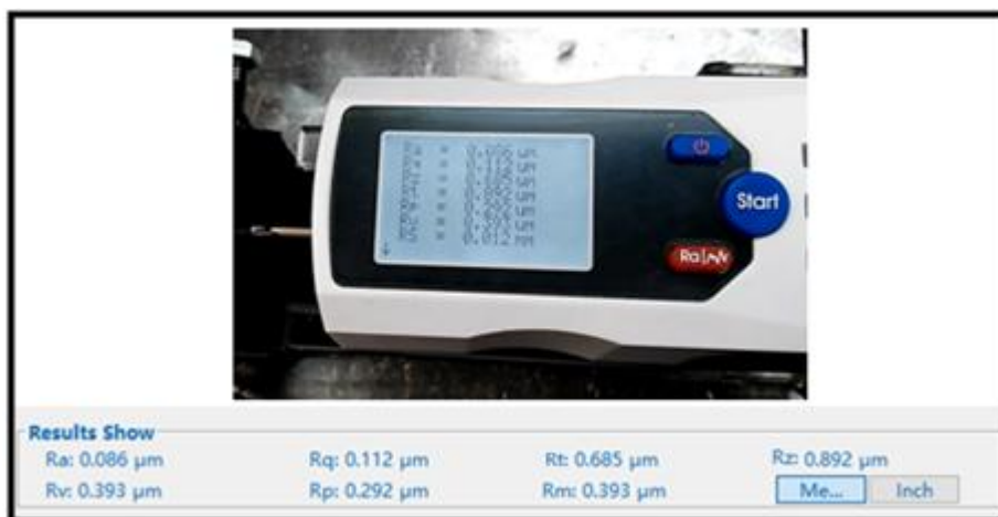
Figura 136. Mediciones de desgaste arrojados del rugosímetro - software
