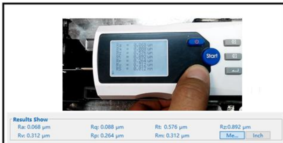
Figura 112. Valores de parámetros en rugosímetro y software (cono)
