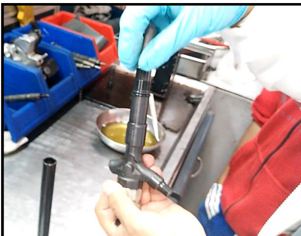
Figura 92. Extracción del conjunto tobera del inyector Denso
