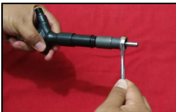
Figura 91. Uso de la herramienta para aflojar la tobera
