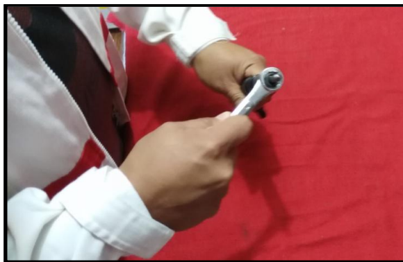
Figura 96. Uso de la herramienta para aflojar la tobera
