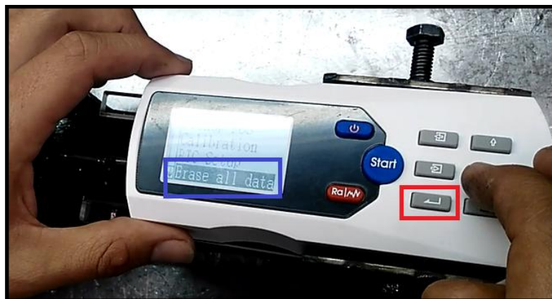
Figura 79. Encerado del rugosímetro
