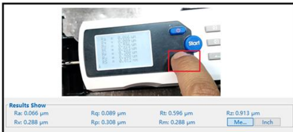
Figura 104. Valores de los parámetros en software y rugosímetro (cono)
