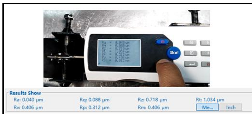
Figura 120. Mediciones de parámetros en ambos dispositivos
