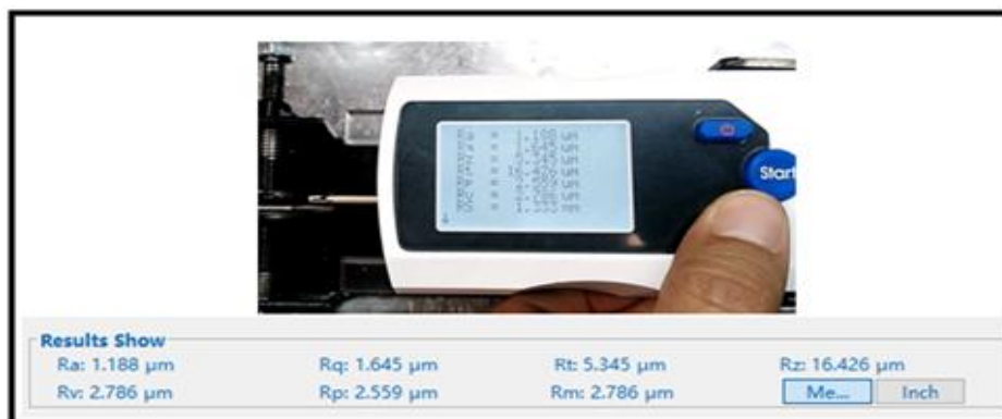
Figura 107. Valores de los parámetros en software y rugosímetro (vástago)
