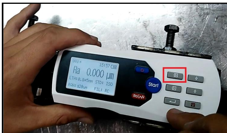
Figura 80. Rugosímetro listo para la medición
