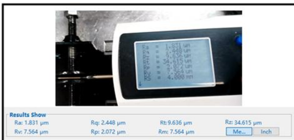
Figura 132. Mediciones de desgaste arrojados
