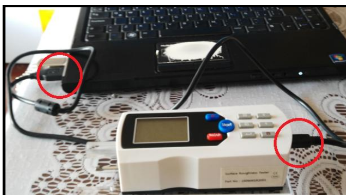
Figura 75. Conexión del cable USB al computador
