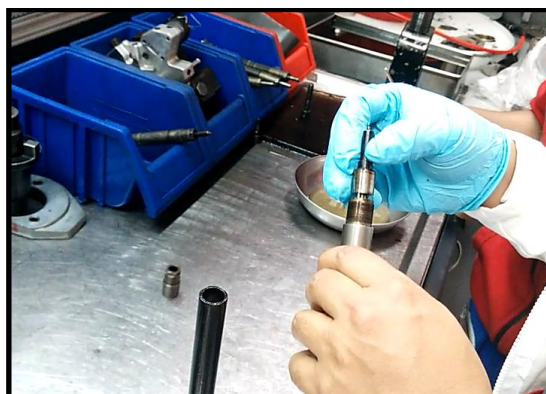
Figura 87. Desarme del conjunto de la tobera
