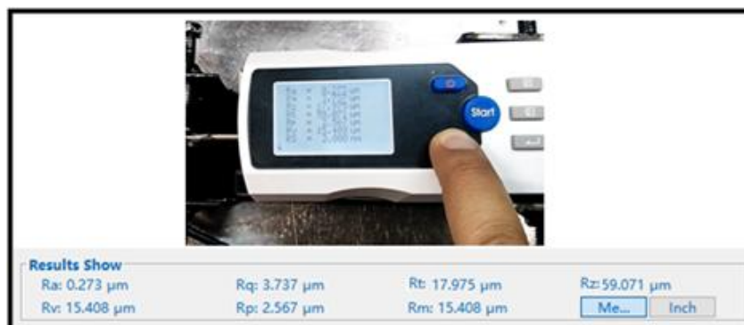
Figura 124. Datos de parámetro de rugosidad en software y rugosímetro
