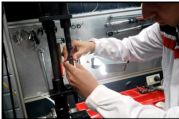
Figura 95. Fijación del inyector DELPHI a la prensa
