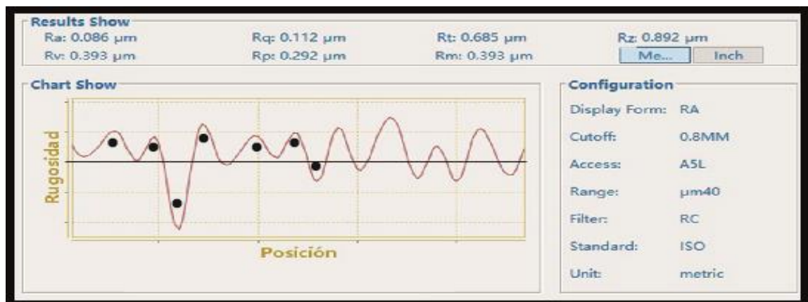
Figura 170. Rugosidad punta cónica de la aguja de Tobera inyector Denso
