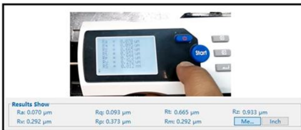
Figura 144. Mediciones de desgaste arrojados del rugosímetro - software
