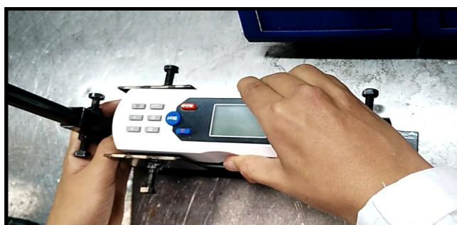
Figura 72. Ubicación del rugosímetro en el pedestal
