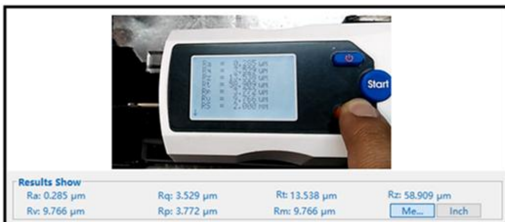
Figura 140. Mediciones de desgaste arrojados del rugosímetro - software
