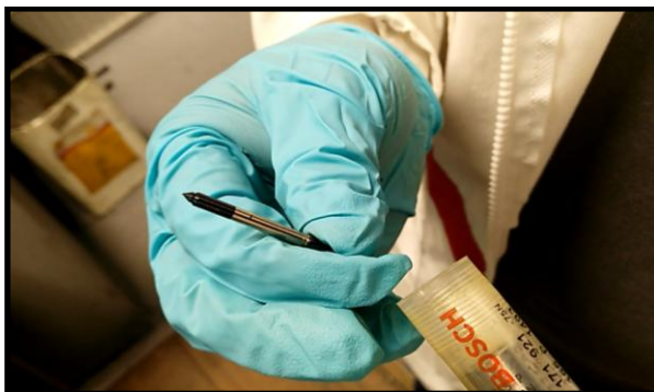
Figura 100. Tobera nueva de marca Bosch
