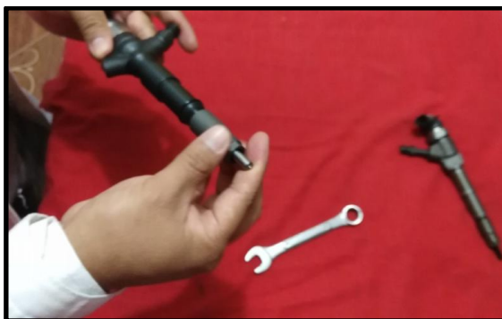
Figura 86. Extracción de la tobera (Bosch)
