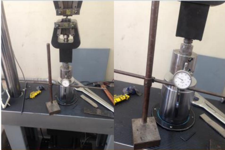
Figura 43: Proceso de obtención del desplazamiento del pistón mediante reloj comparador.
