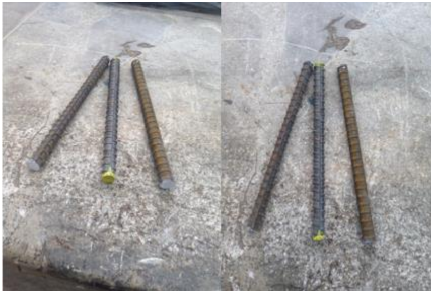
Figura 21: Probetas Estándar finales, marcas Amarillo y Blanco (Ø10 mm).
