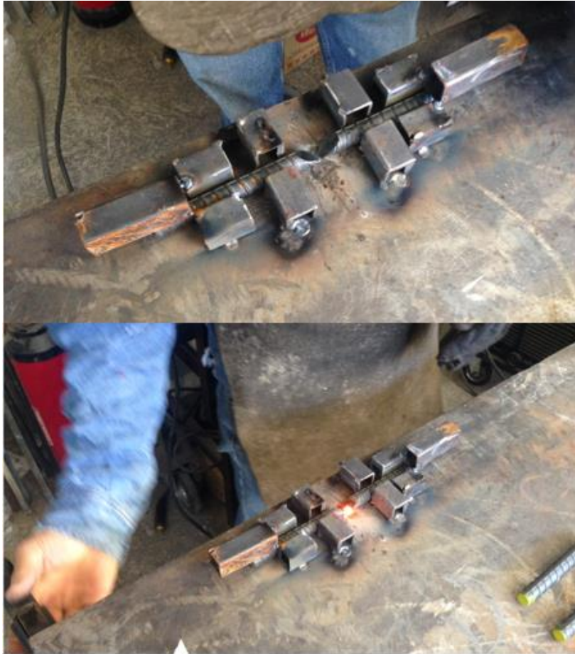
Figura 26: Proceso de soldadura probeta marca Amarillo ( \varnothing 12 mm).
