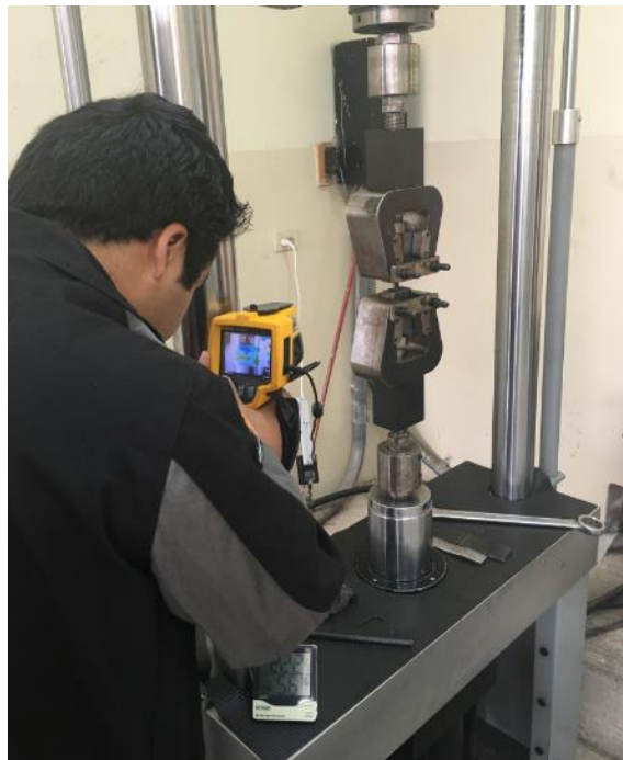
Figura 35: Obtención de Termografías el momento de los ensayos en las varillas de acero corrugado.
