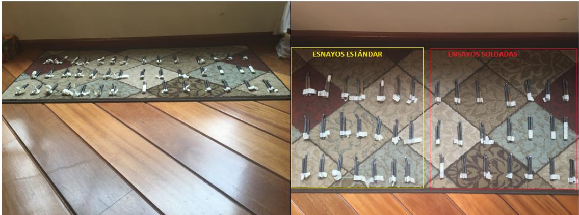
Figura 40: Varillas de acero corrugado de 8 mm de diámetro ensayadas en las dos condiciones establecidas: Estándar y Soldadas.
