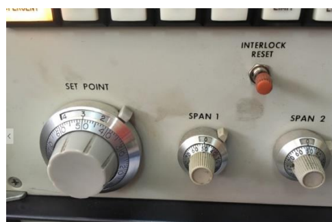
Figura 30: Imagen de los controladores programables de la máquina universal de ensayos MTS.
