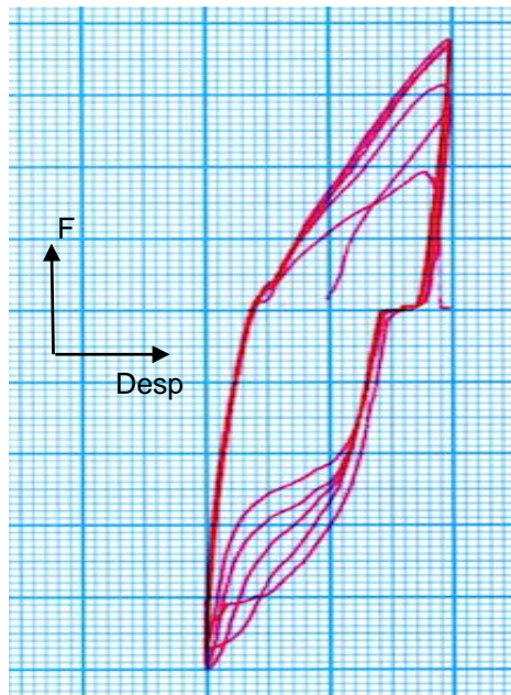
Figura 52: Gráfica del ciclo de histéresis, Cuarto ensayo, varilla de acero corrugado – Soldada, marca AMARILLO, diámetro 8 mm.
