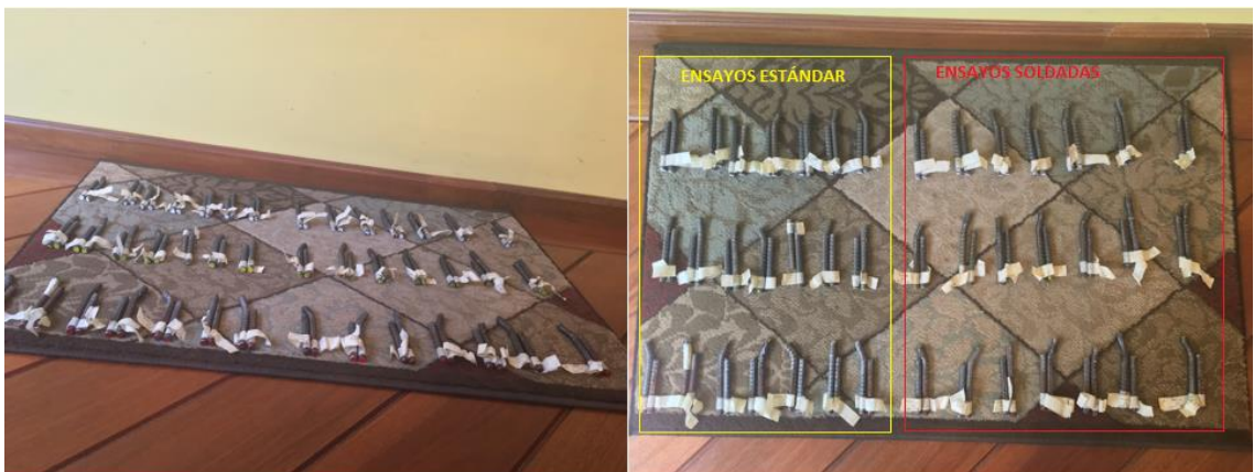
Figura 39: Varillas de acero corrugado de 10 mm de diámetro ensayadas en las dos condiciones establecidas: Estándar y Soldadas.
