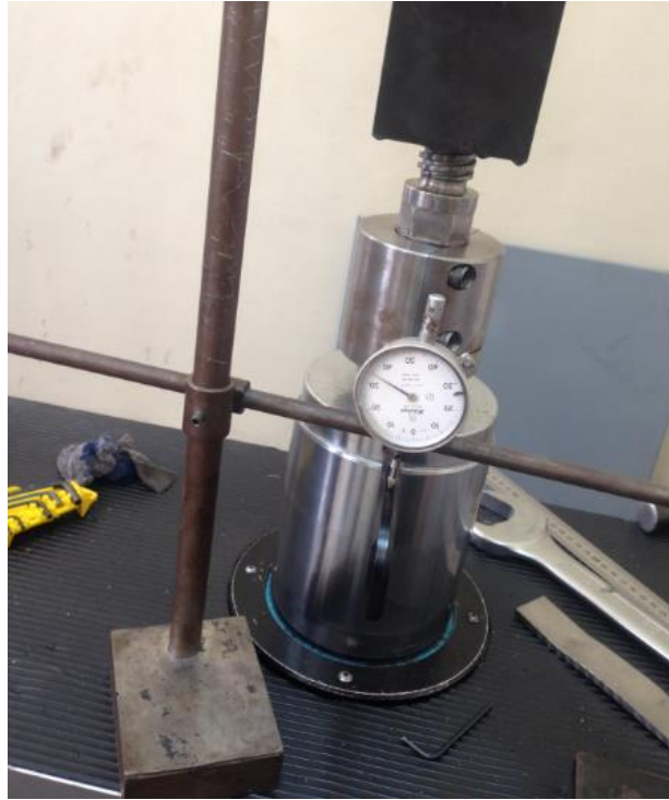
Figura 31: Medición del desplazamiento del pistón por medio de un reloj comparador.
