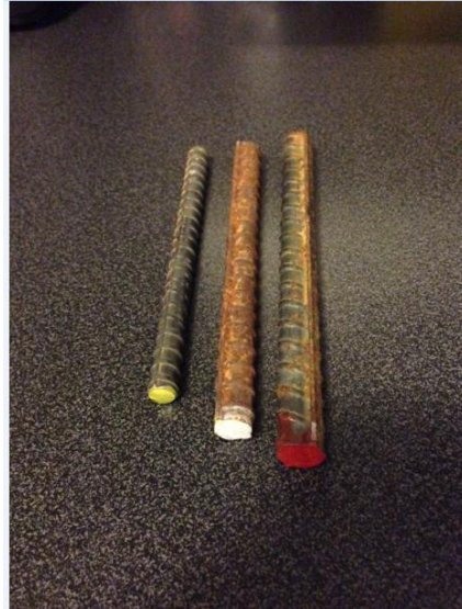
Figura 20: Probetas Estándar finales, marcas Amarillo (Ø8 mm), Blanco (Ø10 mm) y Rojo (Ø12 mm).
