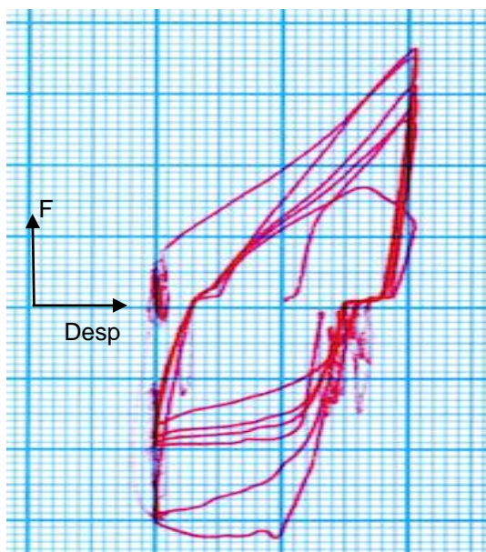
Figura 64: Gráfica del ciclo de histéresis, Quinto ensayo, varilla de acero corrugado – Soldada, marca ROJO, diámetro 8 mm.
