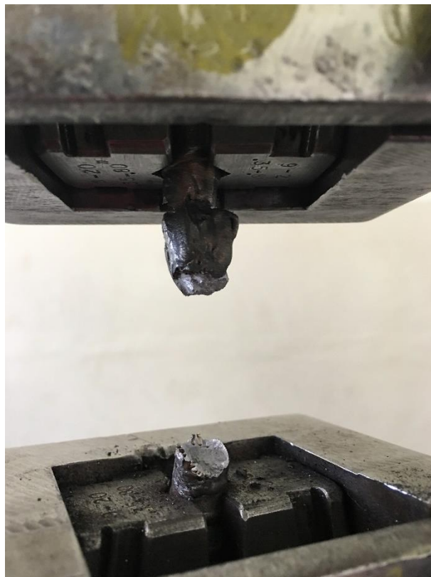
Figura 37: Rotura de la varilla al finalizar el ensayo.
