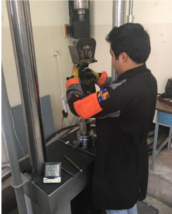
Figura 34: Montaje de varilla previo al ensayo de fatiga de bajos ciclos.
