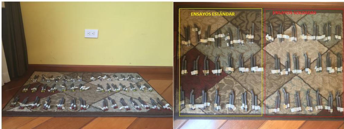
Figura 38: Varillas de acero corrugado de 12 mm de diámetro ensayadas en las dos condiciones establecidas: Estándar y Soldadas.
