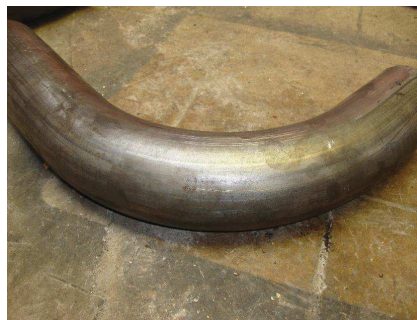
Figura 92: Doblado de Tubo
