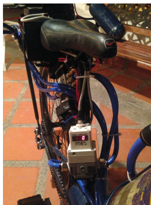
Figura 103: Montaje Regulador de Presión Electrónico
