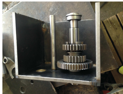
Figura 98: Construcción Caja de Cambios
