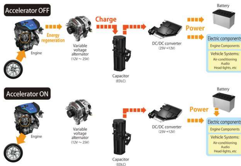
Figura 18: Frenado Regenerativo Eléctrico.
