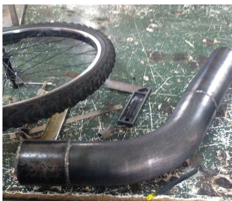
Figura 93: Acumulador de Aire de la Estructura
