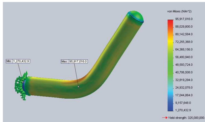
Figura 49: Simulación Acumulador de Aire Comprimido
