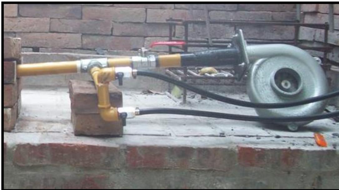
*Figura 71. Quemador de pre mezcla.*
