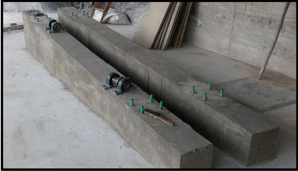
*Figura 66. Bastidor del horno secador de arena.*
