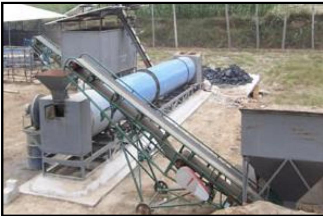
*Figura 6. Horno secador de arena HJSZ.*
