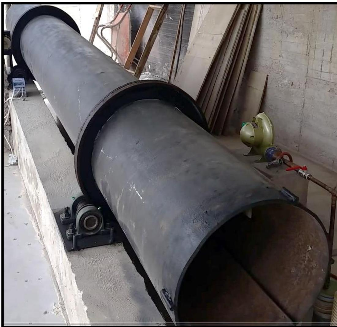
*Figura 73. Instalación de la cámara de secado.*
