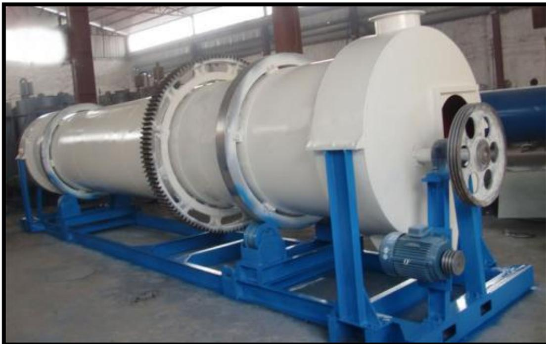
*Figura 8. Horno secador de arena ZYMM.*
