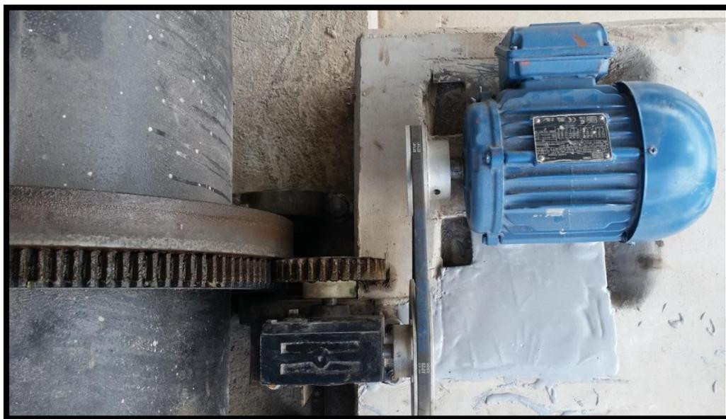
*Figura 78. Sistema de transmisión de movimiento.*
