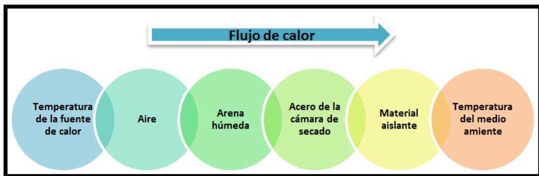
*Figura 16. Flujo de calor entre acero y aislante.*
