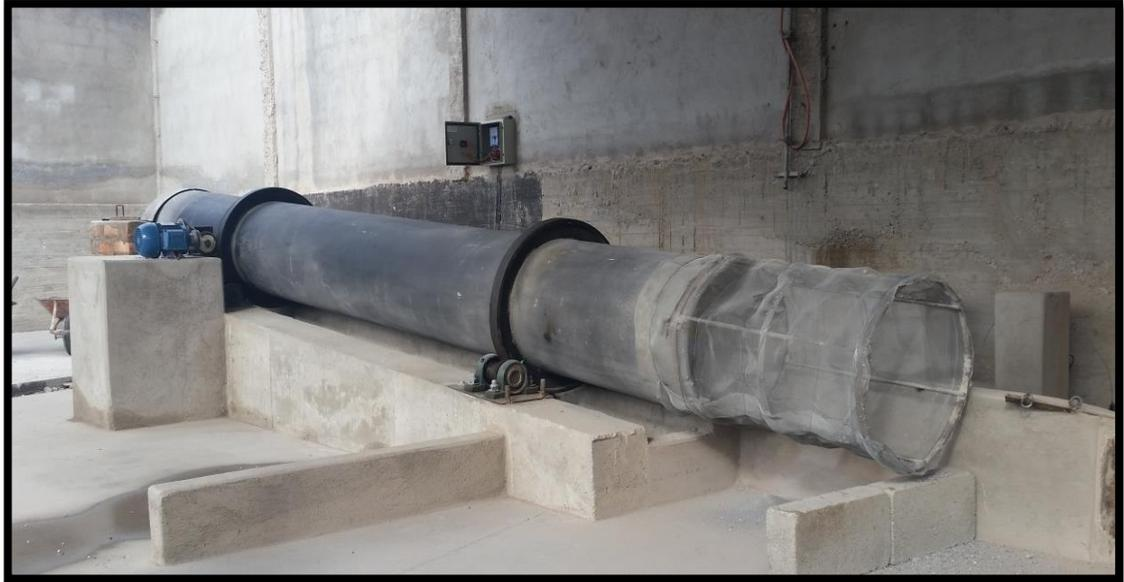
*Figura 82. Horno secador de arena.*
