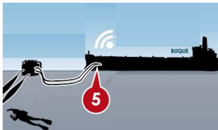
Figura 14 Conexión mangueras flotantes
