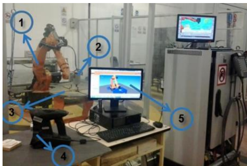
Figura 8 Celda de manufactura robotizada. Brazo Robótico Industrial KUKA KR16 (1). Cabezal fresador Jager (2). Mesa de trabajo (3). Escáner 3D (4). PC (5).
