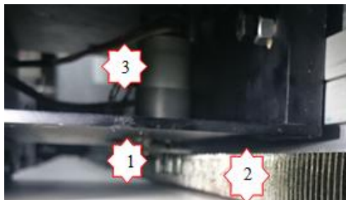
Figura 57 Montaje del mecanismo de Transmisión (1) Piñón, (2) Cremallera, (3) Motor reductor 131:1.
