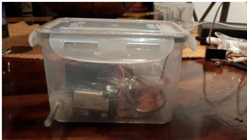
Figura 11: Protecciones herméticas de las motas.
