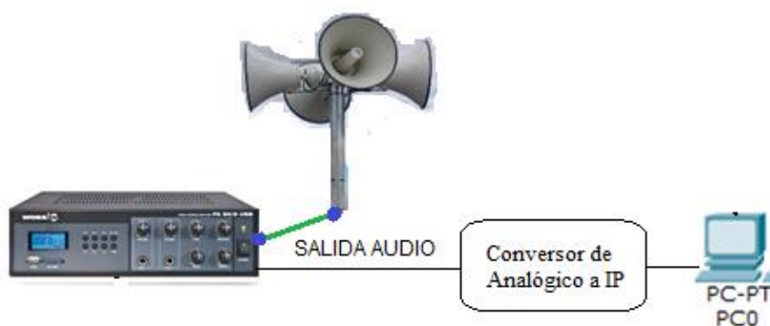
Figura 10. Esquema general del Sistema de alerta Temprana y Seguridad ciudadana.
