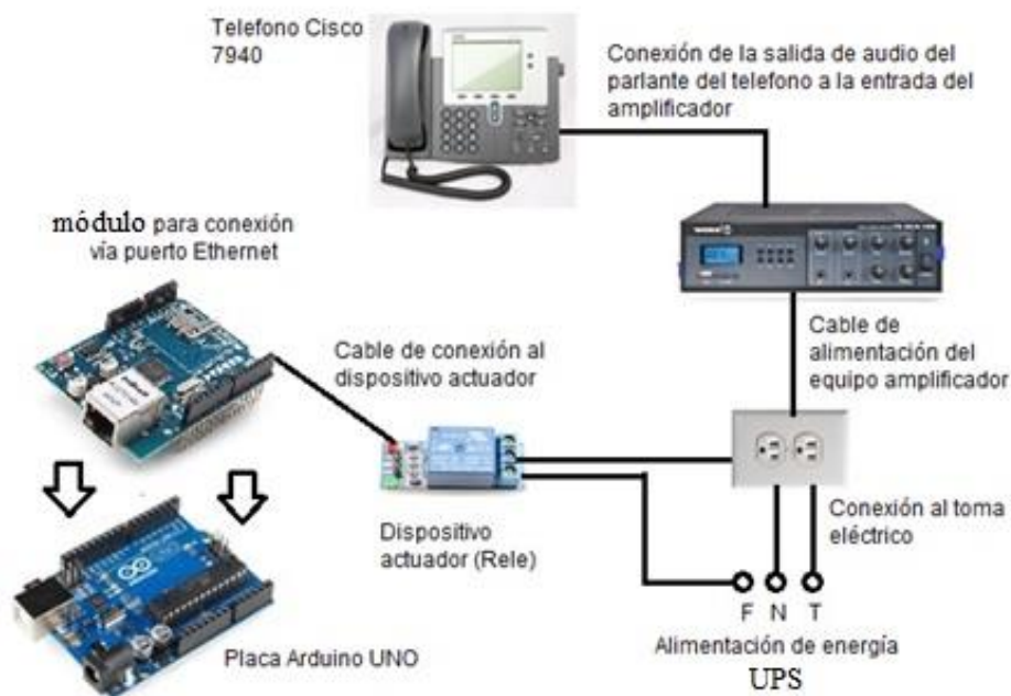
Figura 16. Esquema del hardware para control del Sistema de Alerta Temprana
