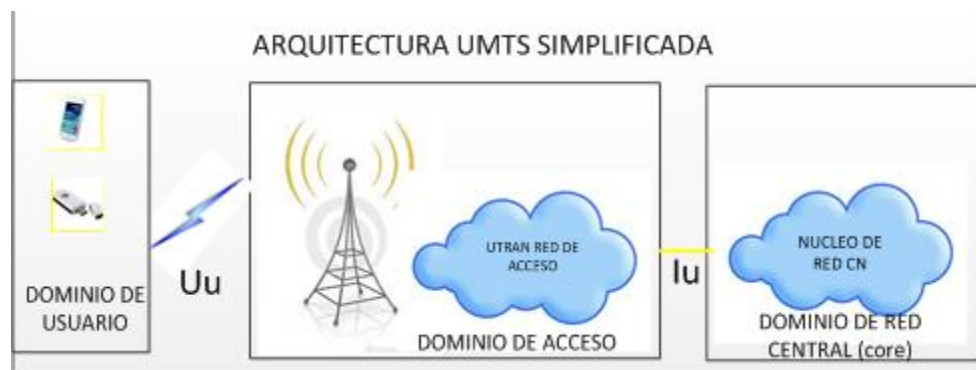
Figura 3 Arquitectura Simplificada de una red UMTS [1] [3]
