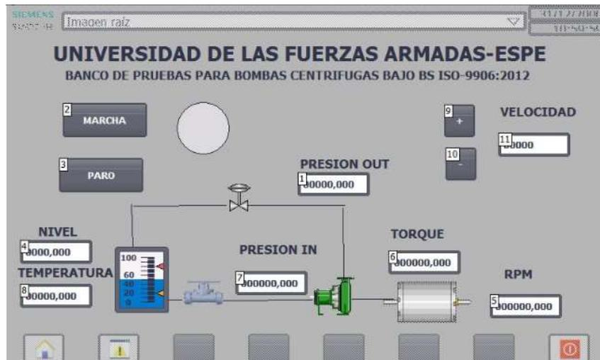
Figura 50. HMI banco de pruebas para bombas centrifugas.
