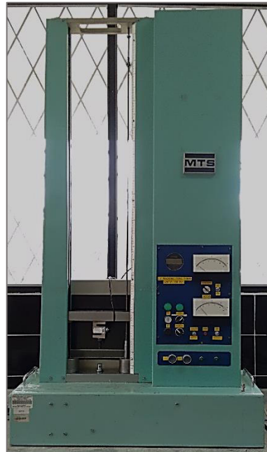
Figura 20 Máquina de ensayos MTS
