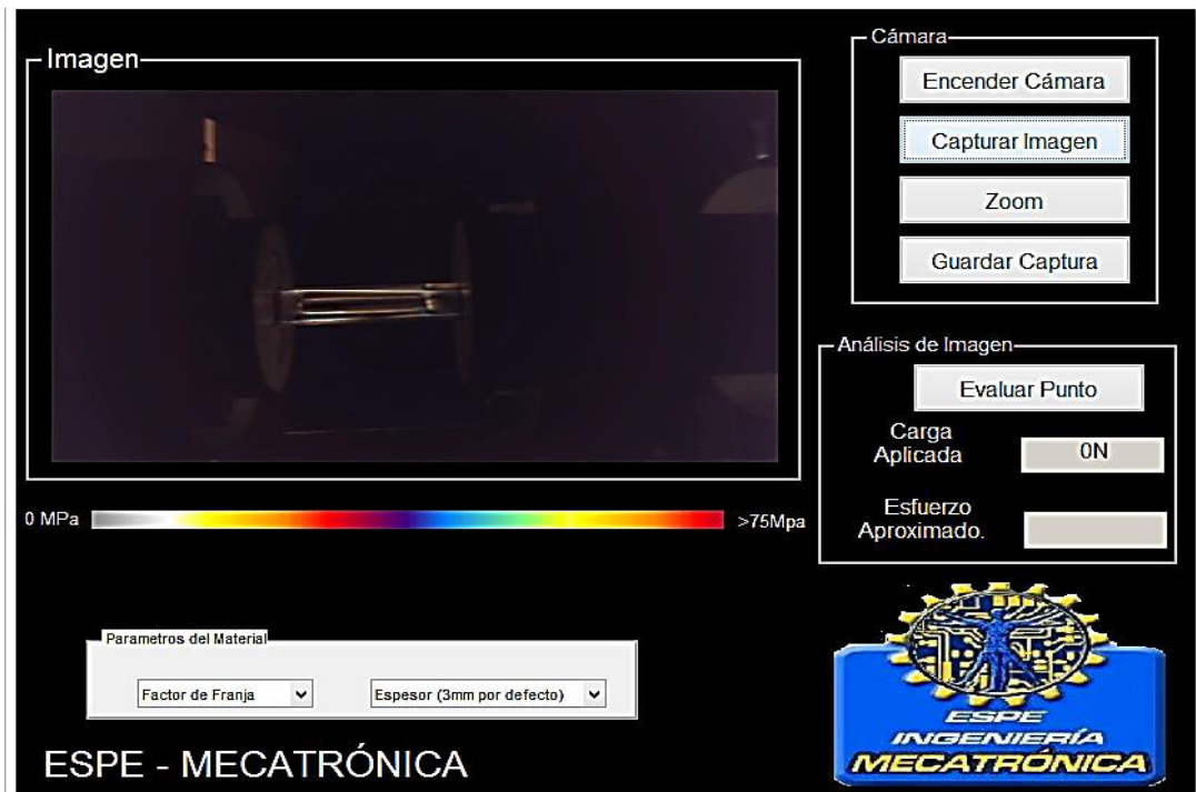
Figura 97 Probeta 2 torsión a 4000Nmm
