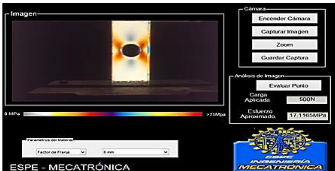
Figura 78 Probeta 6 tracción a 900N
