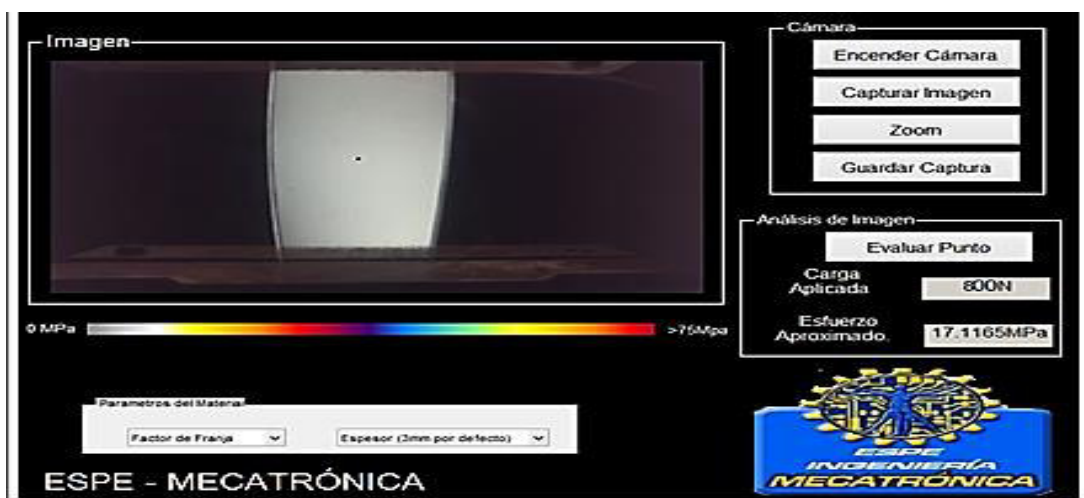
Figura 82 Probeta 1 compresión a 800N
