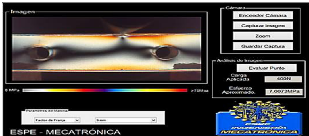
Figura 87 Probeta 1 flexión a 400N
