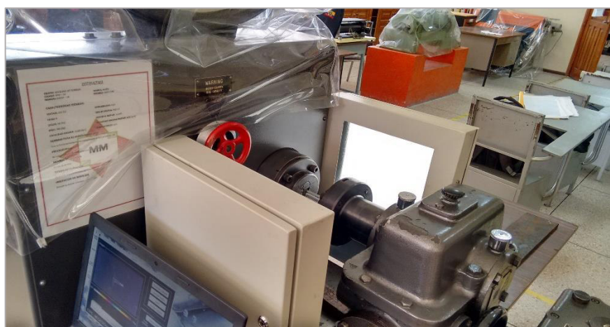
Figura 59 Montaje ensayo torsión
