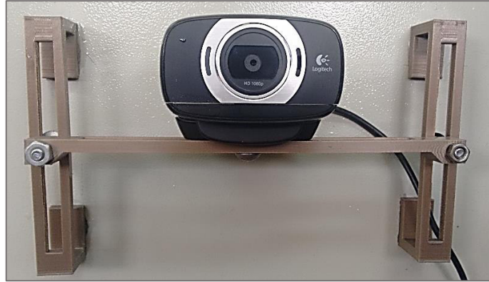
Figura 32 Guías de cámara implementadas
