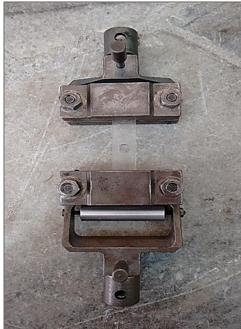
Figura 21 Mordaza de sujeción para tracción y compresión
