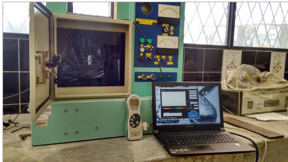
Figura 56 Montaje ensayo tracción
