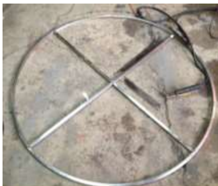
Figura 74: Soldadura mesa de soporte
