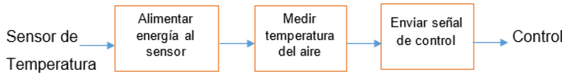
Figura 22: Diagrama de descomposición del problema de control
