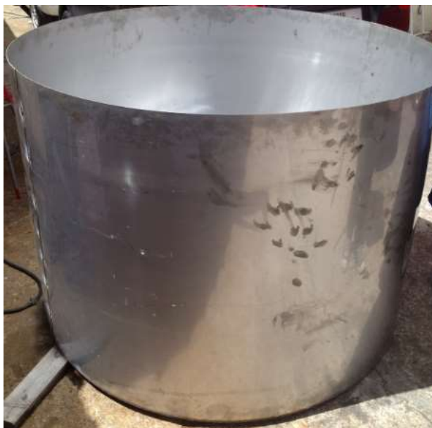
Figura 65: Resultado de planchas de acero roladas
