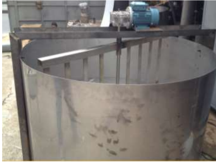
Figura 83: Montaje de motorreductor en pórtico
