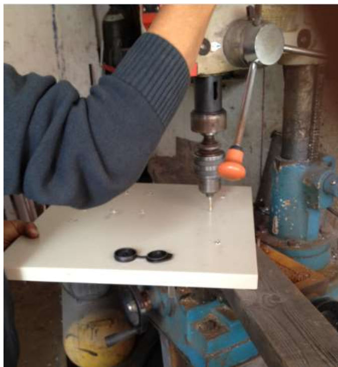
Figura 89: Perforación de agujeros para montaje de HMI
