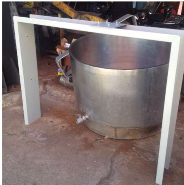
Figura 84: Pintado estructura de pórtico
