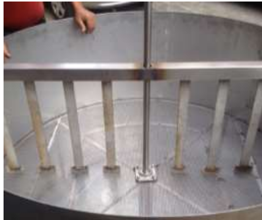
Figura 71: Montaje de removedor
