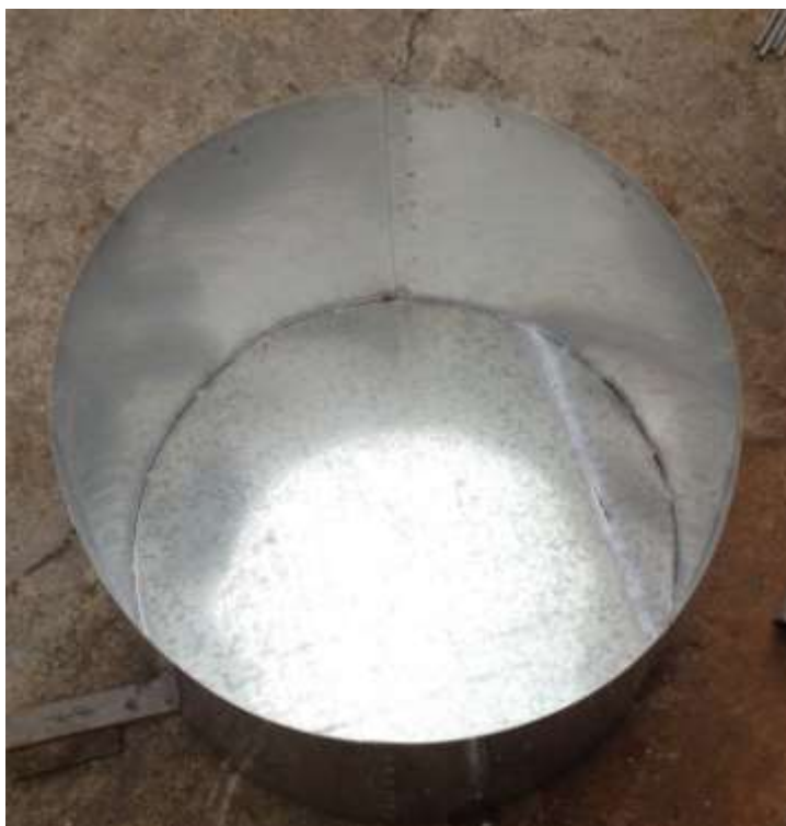
Figura 66: Contenedor de acero inoxidable
