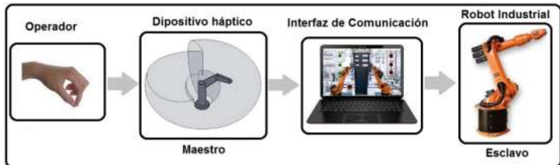
Figura 11. Componentes de un sistema de tipo maestro –esclavo.
