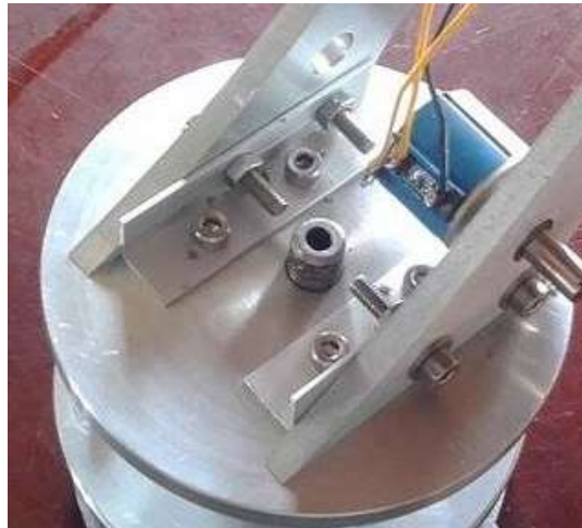
Figura 62. Ensamble de la base y el eslabón 1 mediante tornillos.
