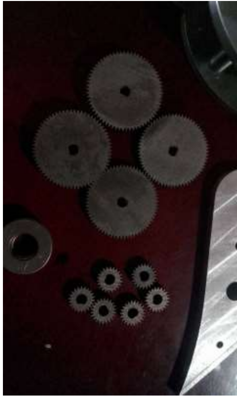
Figura 59. Conjunto de engranes de la cadena cinemática
