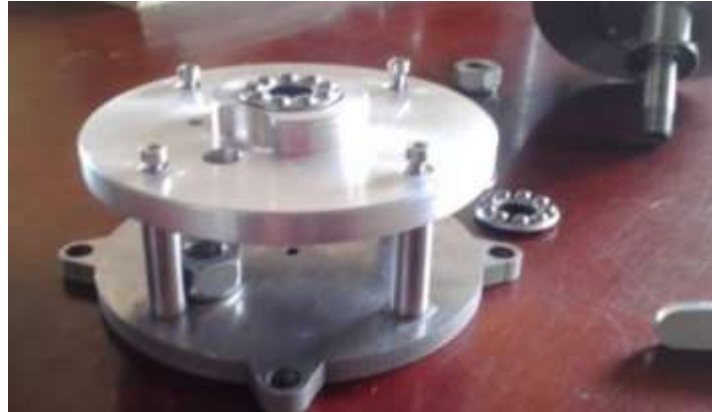
Figura 61. Acoplamiento de los rodamientos axiales a la base
