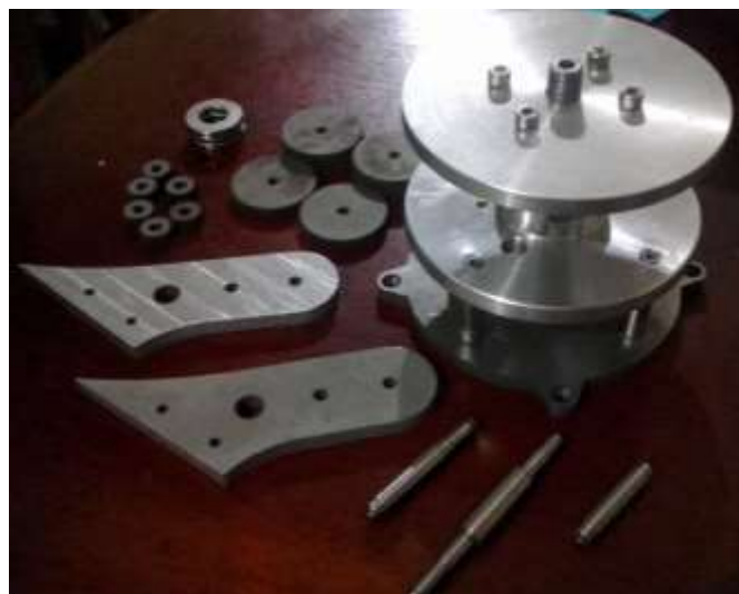
Figura 58. Componentes de la cadena cinemática
