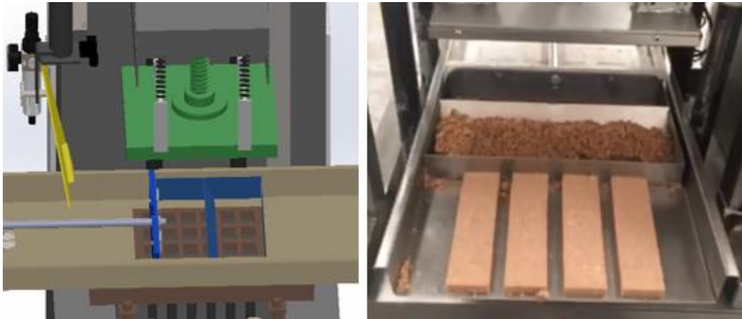
Figura 74. Paleta avanza para desplazar dulces sobre la bandeja.
