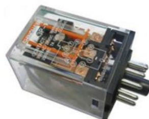
Figura 94. Relé TH-MY4N 8 pines, 3A y 110 V Fuente: (Electrostock, 2016)
