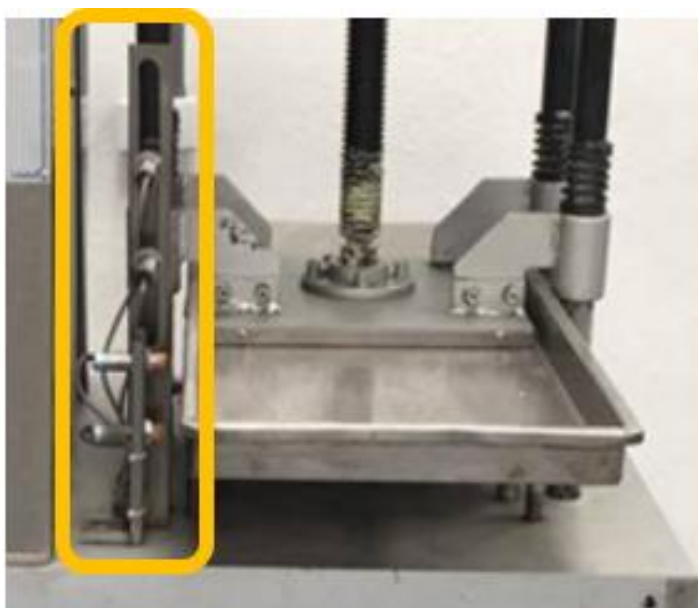
Figura 6. Disposición de los sensores inductivos
