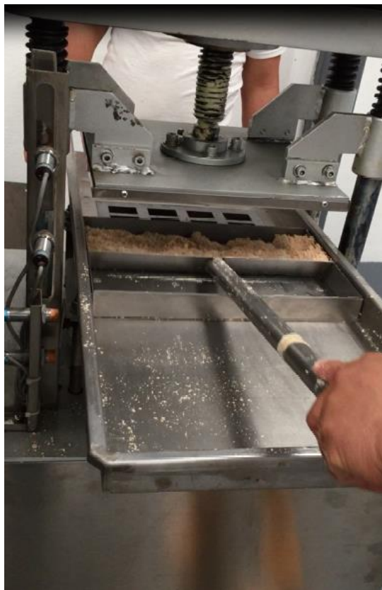
Figura 5. Distribución manual de la mezcla
