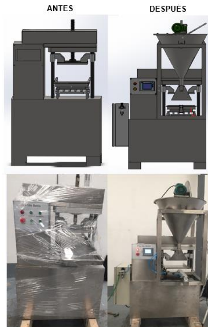
Figura 115. Antes y después de la prensa electromecánica.
