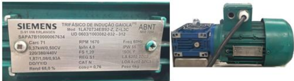
Figura 41. Motor de 0,5 HP y reductor de 1670 rpm a 120 rpm.
