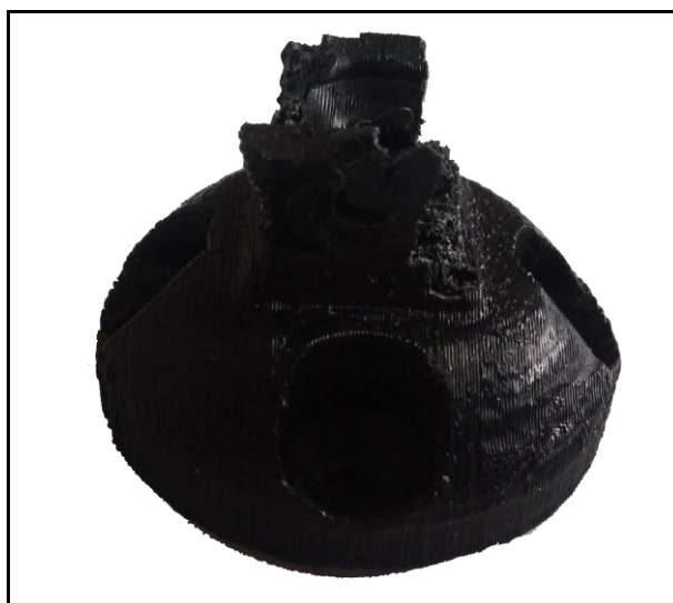
Figura 97. Falla por esfuerzo cortante en el adaptador estándar de pie.
