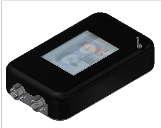
Figura 96. Caja de control para el módulo de rehabilitación
