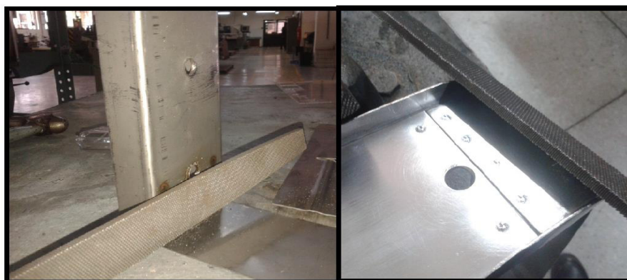
Figura 132.- Proceso de limado de la caja interna de secado
