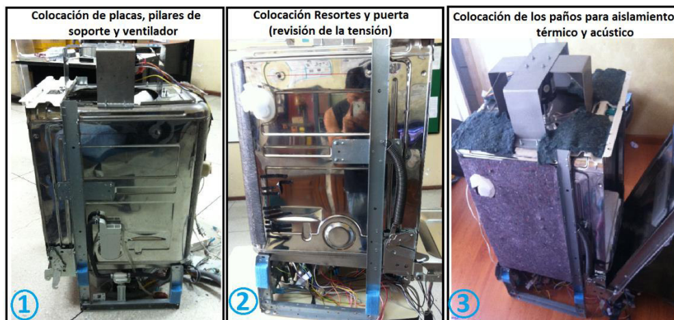
Figura 142.- Ensamble y montaje de la cámara a la estructura
