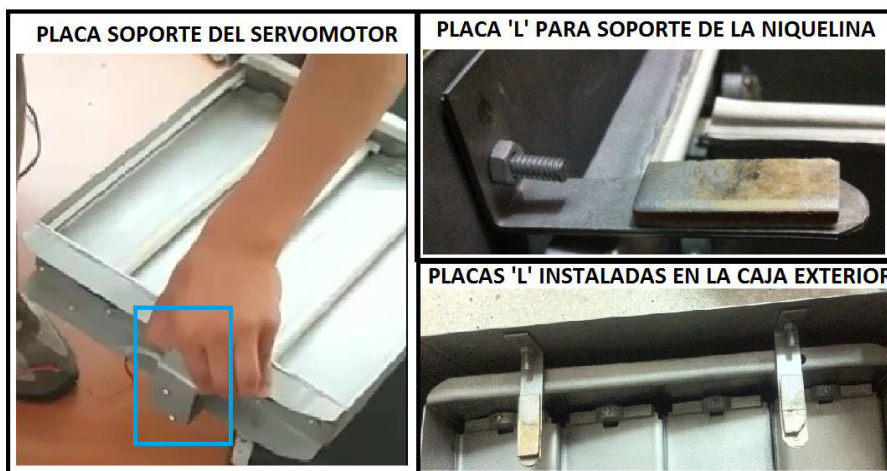
Figura 137.- Placas soporte del servomotor y placas 'L' de la niquelina
