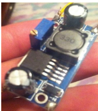
Figura 105.- Convertidor DC/DC LM2596 para Arduino
