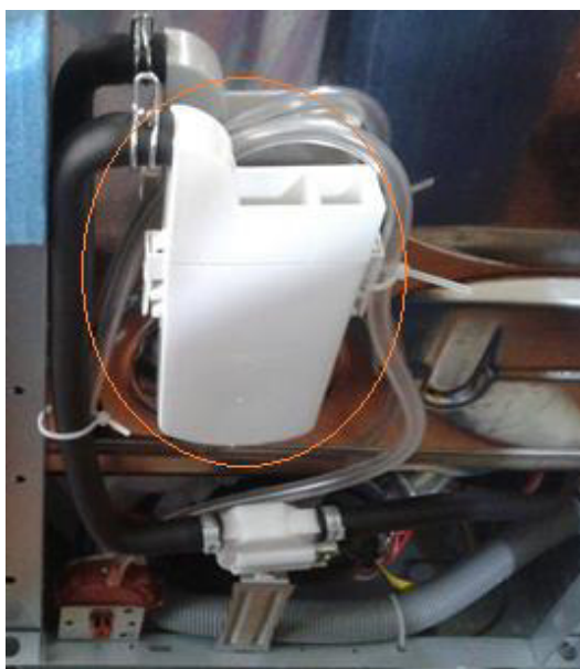
Figura 75.- Disyuntor de aire (aliviador de presiones)
