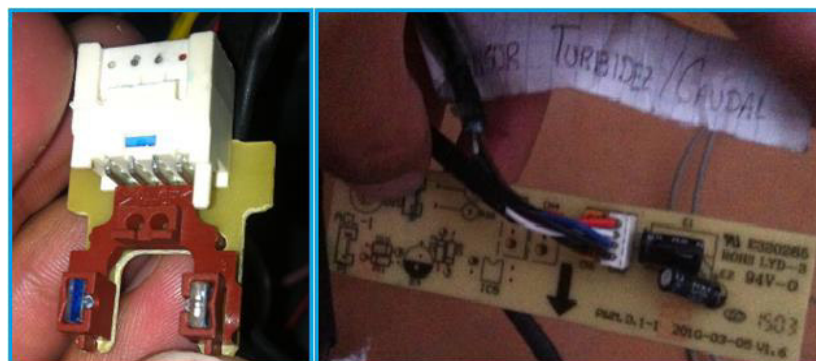
Figura 127.- Sensor de Turbidez: Estructura Interna y PCB propia
