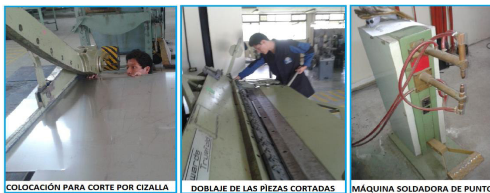
Figura 129.- Procedimiento para corte, doblado y soldadura por punto
