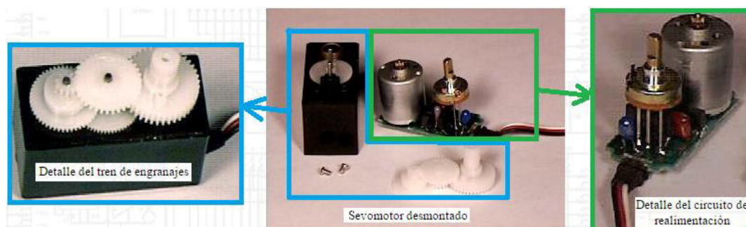
Figura 4.- Partes y Desensamblado de un Servomotor
