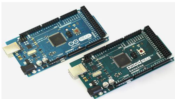
Figura 6.- Tarjeta del controlador Arduino MEGA 2560 (Arduino, Arduino MEGA 2560, 2016)
