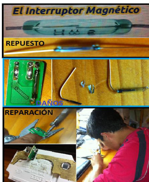
Figura 156.- Reparación y reemplazo de interruptores magnéticos
