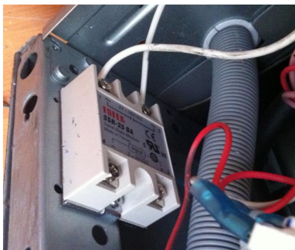
Figura 91.- Implementaci\u00f3n del SSR en el prototipo de la m\u00e1quina
