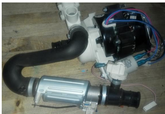
Figura 80.- Bomba de Lavado Implementación en Tubería
