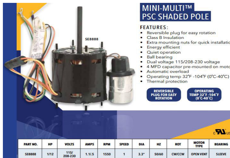
Figura 108.- Especificaciones técnicas del motor del ventilador (SE8888)
