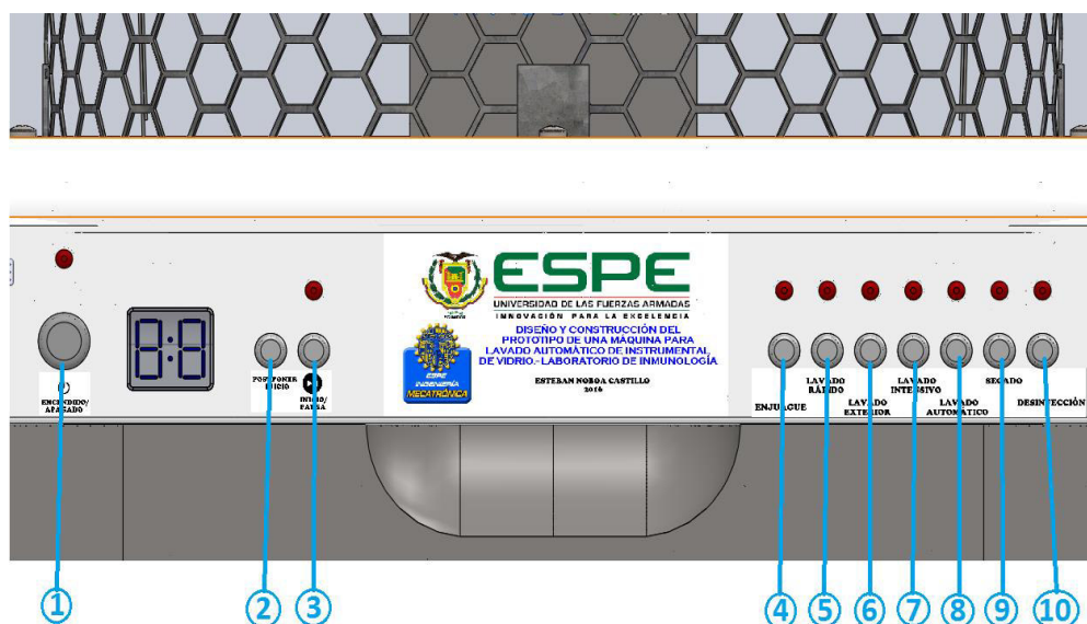
Figura 128.- Panel de Mandos de la Lavadora-Termodesinfectadora Etiquetado
