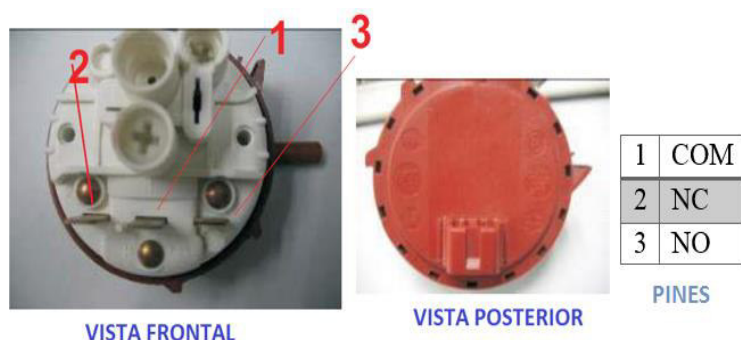
Figura 124.- Presóstato (2 vistas y descripción de terminales)
