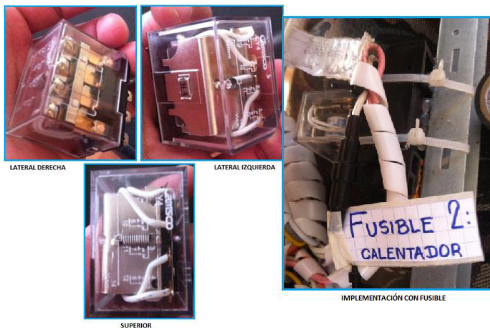
Figura 98.- Relé encapsulado (3 vistas) e implementación
