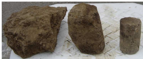
Figura 95 Tallado de probeta
