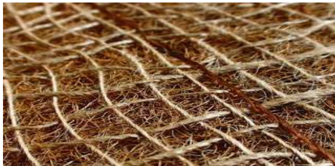
Figura 55 Geomanta de fibras de coco
