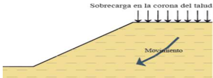
Figura 21 Carga en la cima del talud
