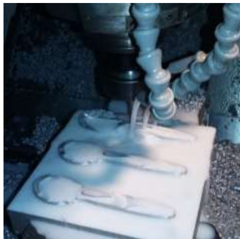
Figura 30. Aplicación de refrigerante soluble oil D.
