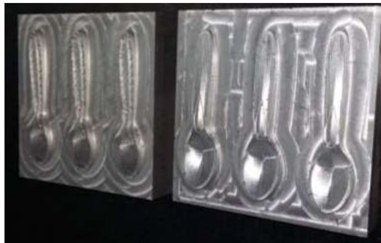
Figura 23. Ejemplo de aplicación de superficies libres molde de cucharas.
