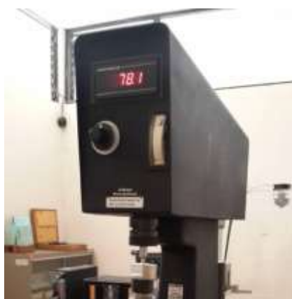
Figura 2 Medición dureza brinell, aleación de aluminio 7075.
