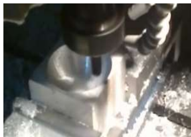
Figura 7. Fresado radial en Aluminio 7075.
