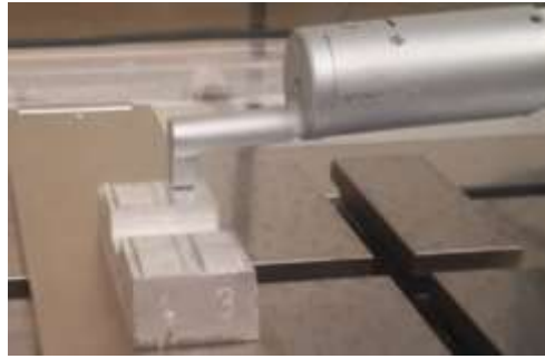
Figura 50. Medición de la rugosidad superficial.
