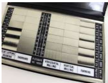
Figura 43. Patrón para comprobación de rugosímetro.
