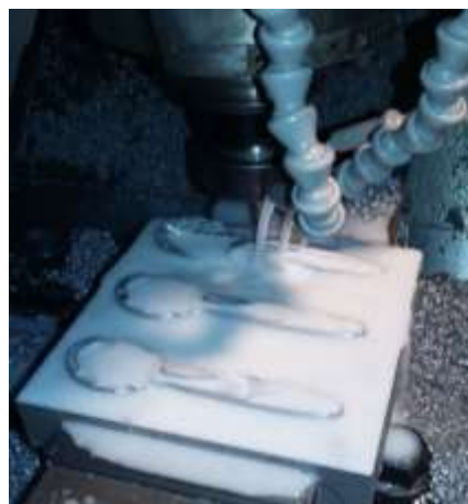
Figura 16. Mecanizado de superficies libres, molde cuchara.
