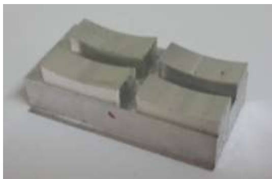
Figura 49 Superficie convexa mecanizada.
