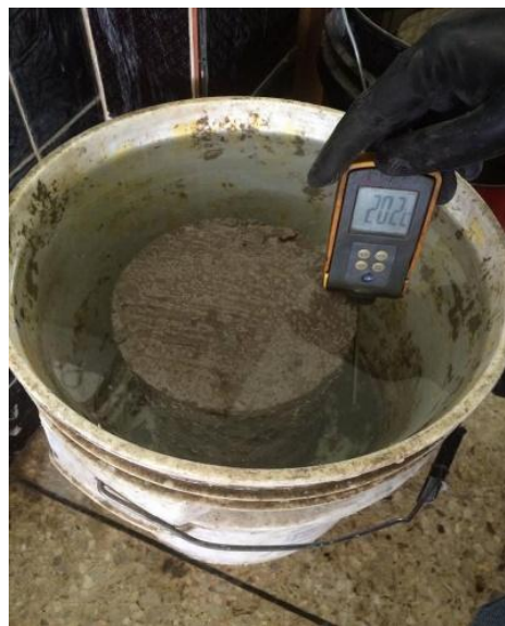
Figura 21 Curado de un cilindro de hormigón y verificación de la temperatura del agua.
