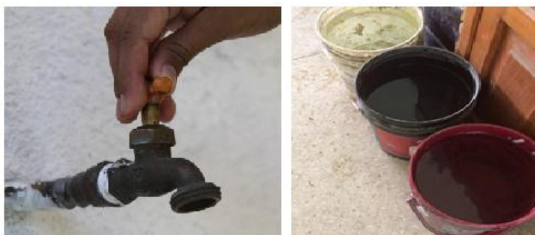
Figura 12 El agua que el hombre usa para beber es ideal para el hormigón.
