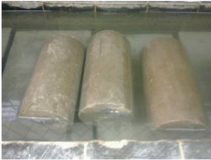
Figura 22 Curado de muestras de hormigón en piscina de curado de la Universidad de las Fuerzas Armadas.
