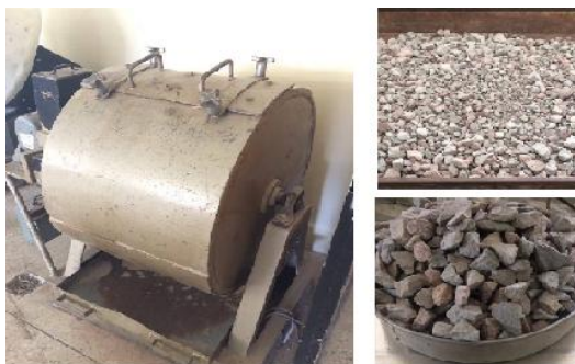
Figura 11 Ensayo de abrasión con la Máquina de los Ángeles
