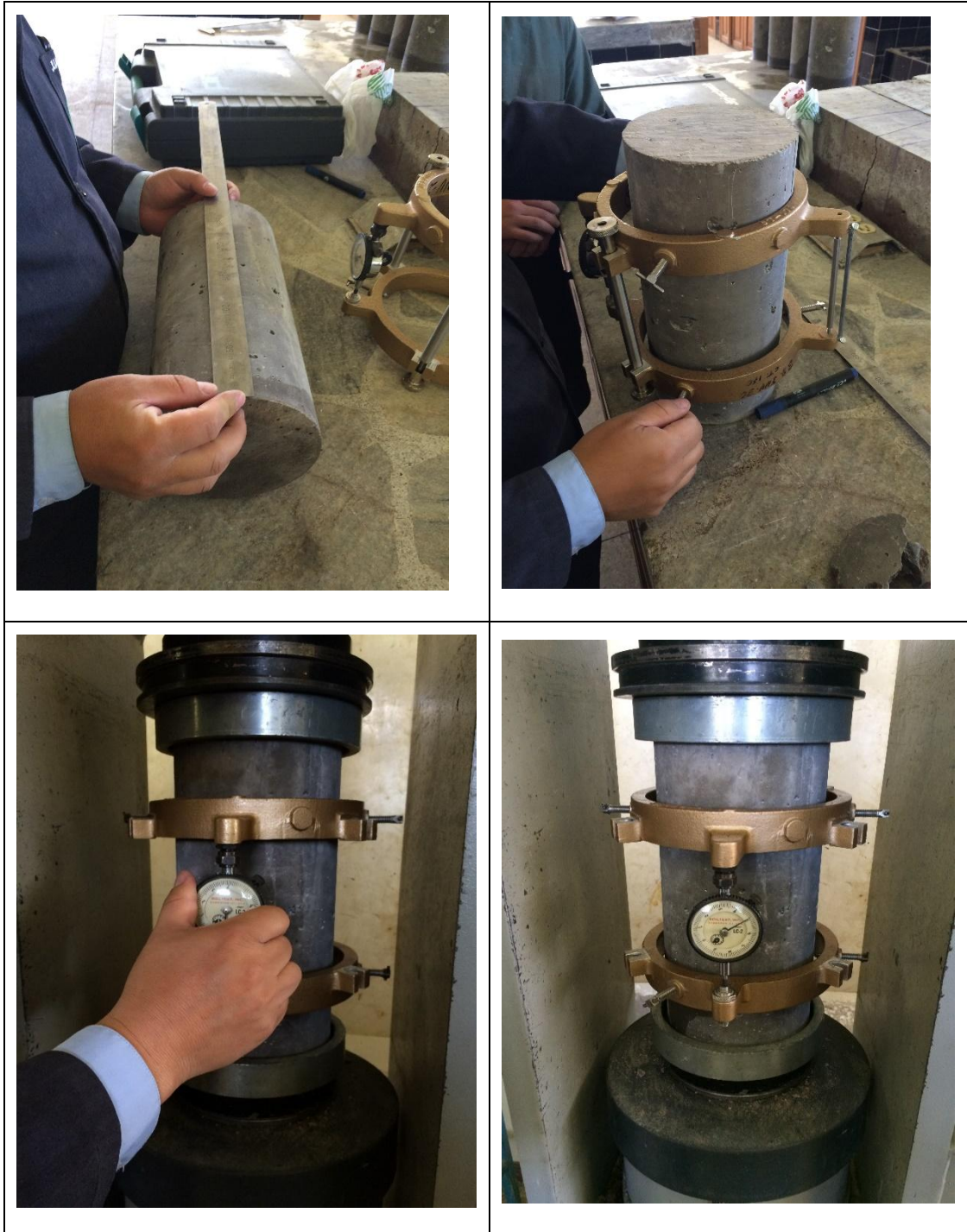
Figura 71 Registro fotográfico del procedimiento para medir deformaciones en el hormigón
