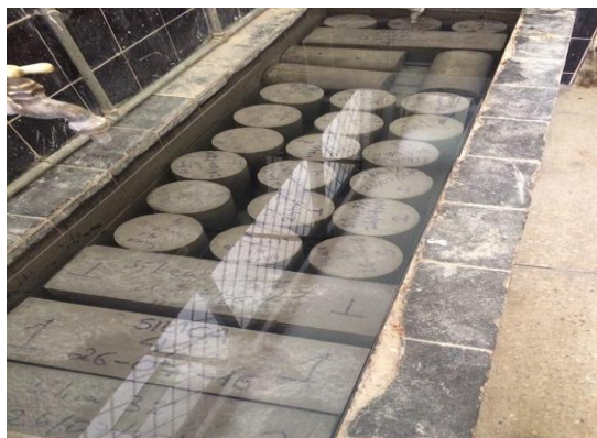
Figura 13 Muestra de hormigón sumergido en agua de curado.
