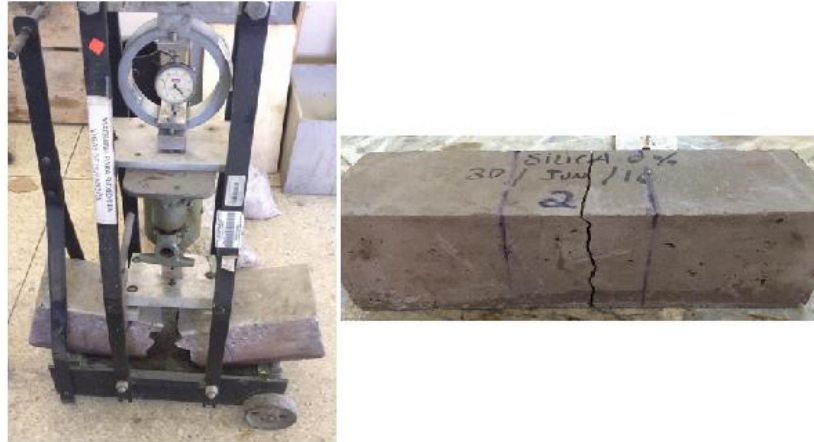
Figura 19 Ensayo a Flexión en vigas de hormigón.
