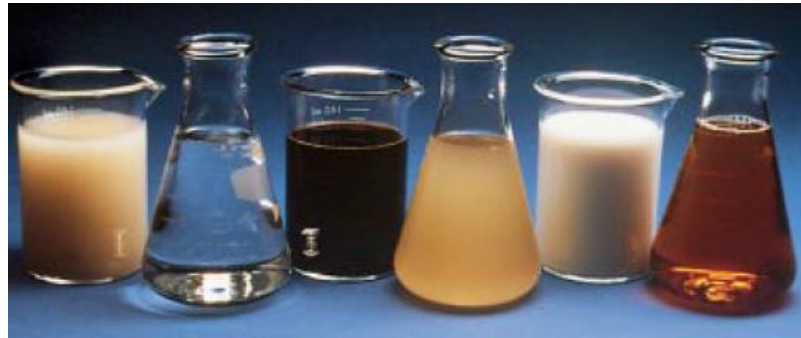
Figura 14 Aditivos líquidos, de izquierda a derecha: “aditivo antideslave, reductor de retracción, reductor de agua, agente espumante, inhibidor de corrosión y incorporador de agua”. Fuente: (Rivera, 2013)
