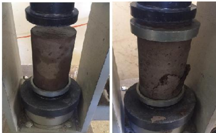
Figura 18 Ensayo a la compresión de Cilindros de hormigón.
