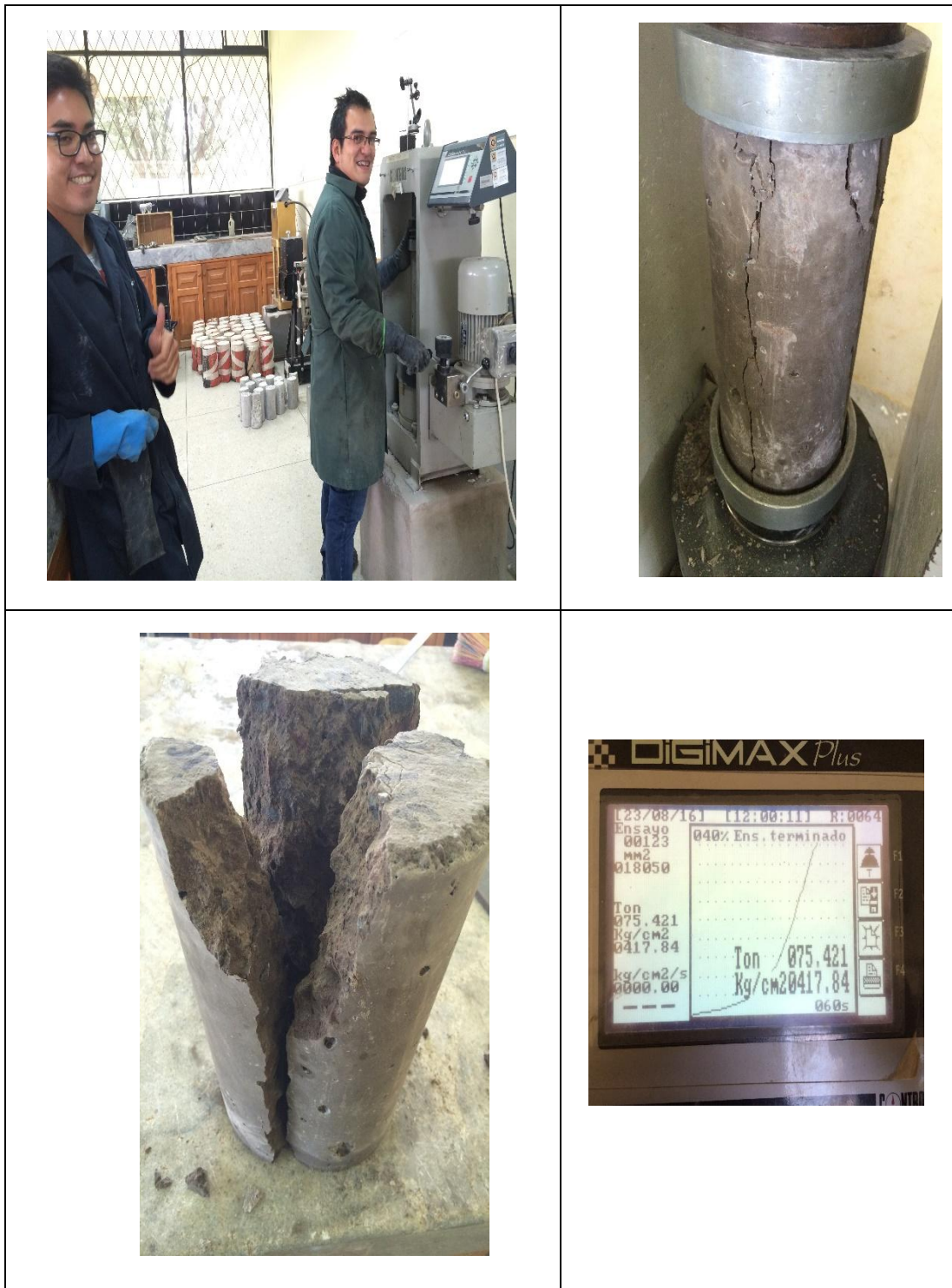
Figura 59 Registro fotográfico del procedimiento de ensayo de compresión a los cilindros de hormigón.
