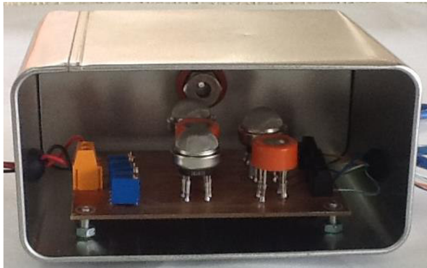
Figura 16. Bloque de sensado acoplado y terminado
