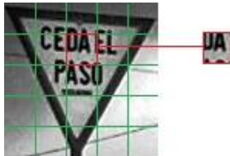
Figura 43. División de una imagen en 25 celdas; 5 celdas verticales y 5 celdas horizontales.
