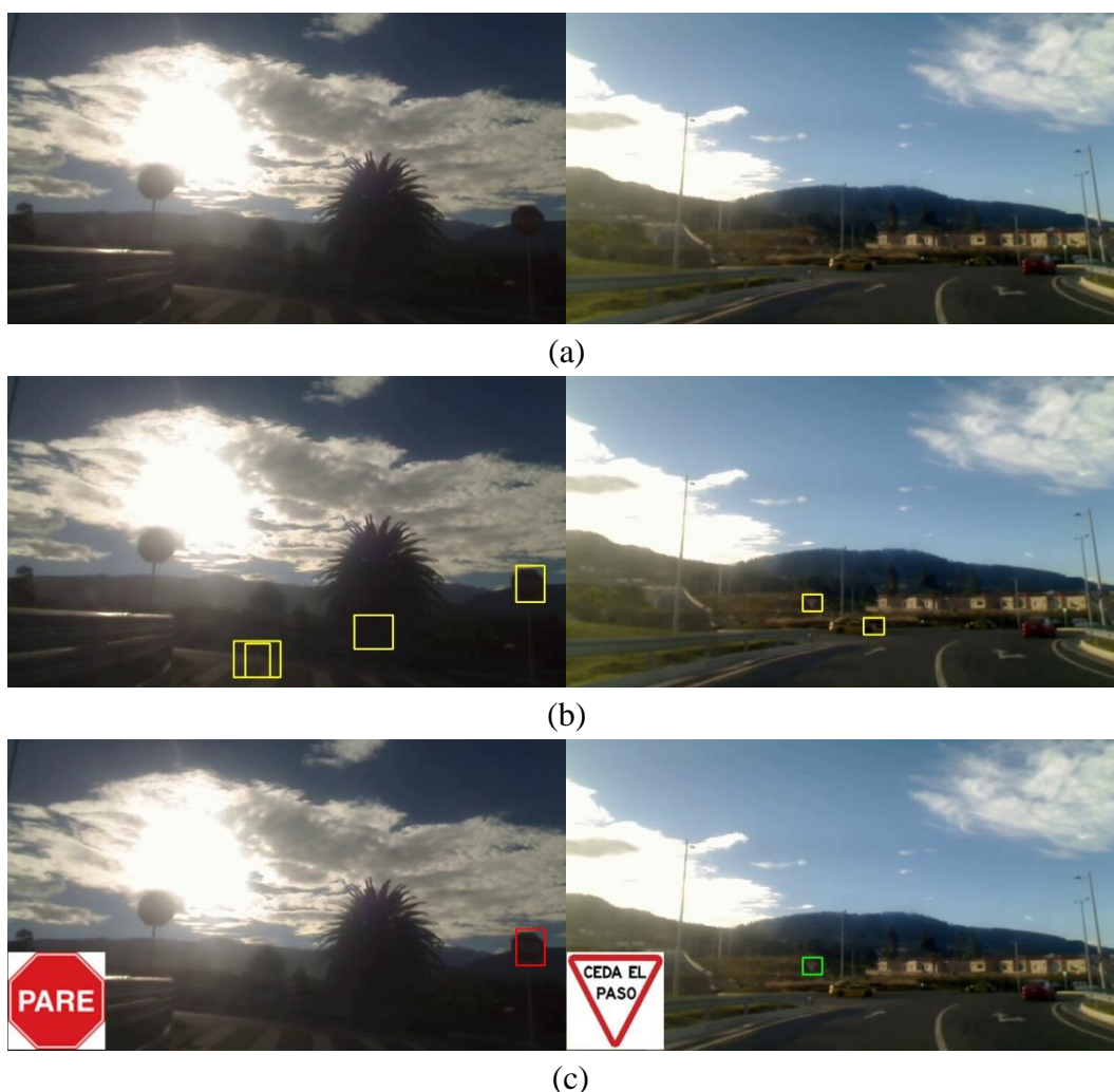
Figura 56. Pruebas de funcionamiento en condiciones iluminación soleado para señales de pare (izquierda) y ceda el paso (derecha): (a) imagen original, (b) generación de las regiones de interés, (c) respuesta del sistema.
