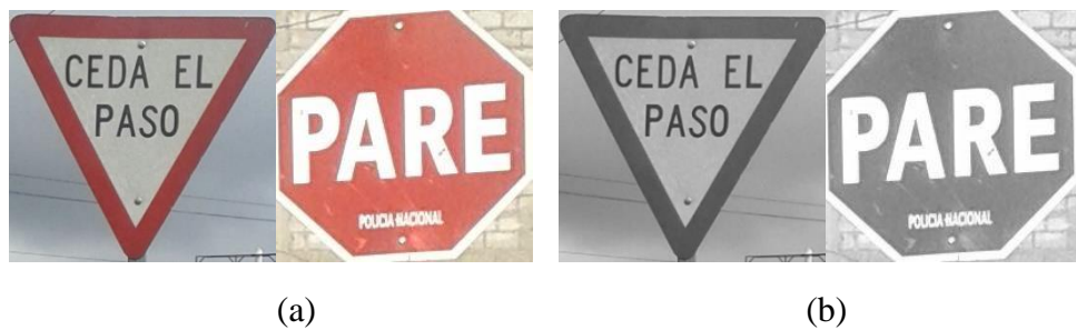
Figura 37. Transformación a escala de grises en señales de Ceda el Paso (izquierda) y Pare (derecha): (a) imágenes originales, (b) imágenes en escala de grises.
