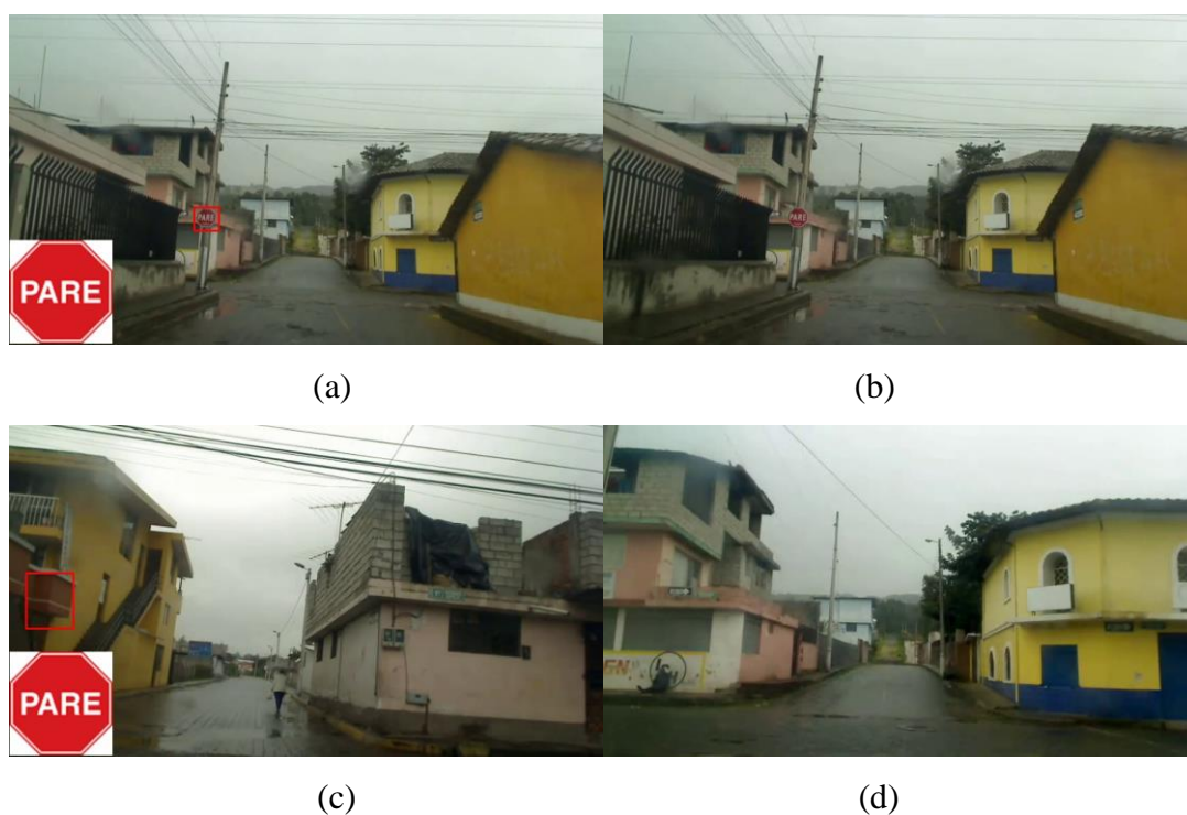
Figura 62. Respuestas del sistema: (a) real positivo, (b) falso negativo, (c) falso positivo, (d) real negativo.
