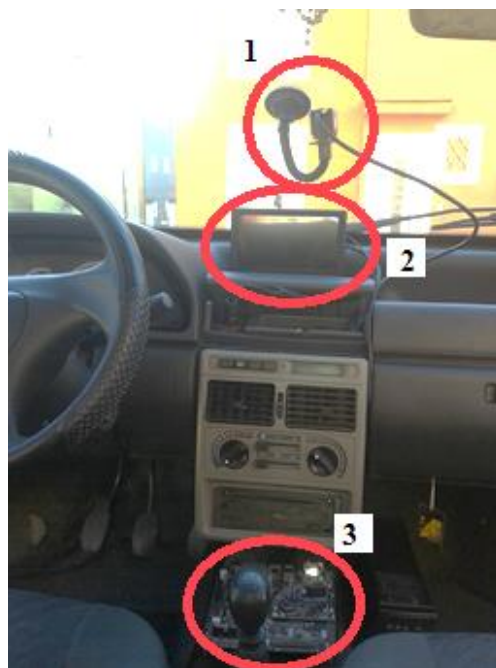
Figura 55. Instalación del sistema de percepción, visualización y procesamiento en un vehículo.
