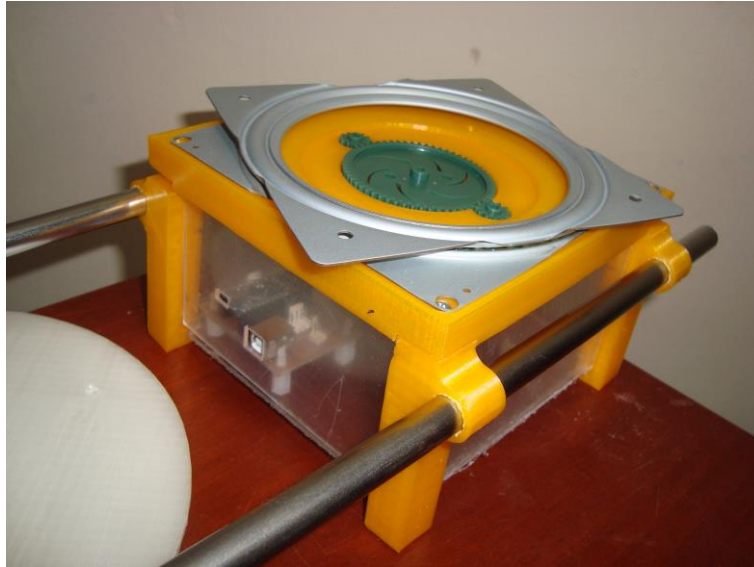
Figura 66 Ensamble de engranes y acomple de la mesa giratoria.
