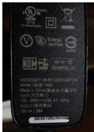
Figura 36 Características del adaptador de corriente de Microsoft Kinect para Windows.
