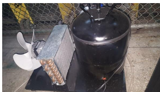
Figura 4: Sistema de refrigeración de la plataforma CNC de corte por láser. Fuente: (Cazco & Gordon, 2015)
