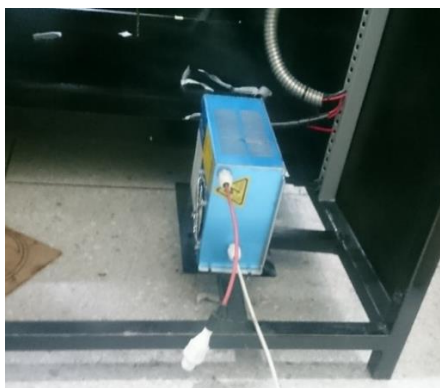
Figura 78: Ubicación de la fuente del tubo láser en la plataforma.
