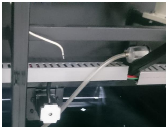
Figura 60: Ubicación del sensor de temperatura en el soporte del tubo láser.
