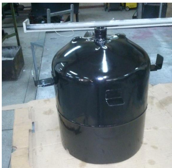
Figura 54: contenedor de agua destilada con recubrimiento anticorrosivo.
