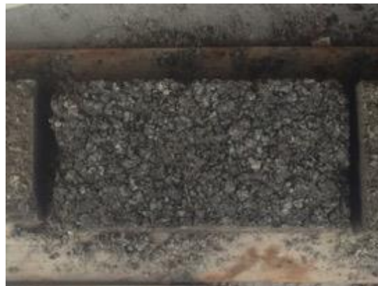
Figura 19. Tercer modelo desencofrado y en proceso de curado.
