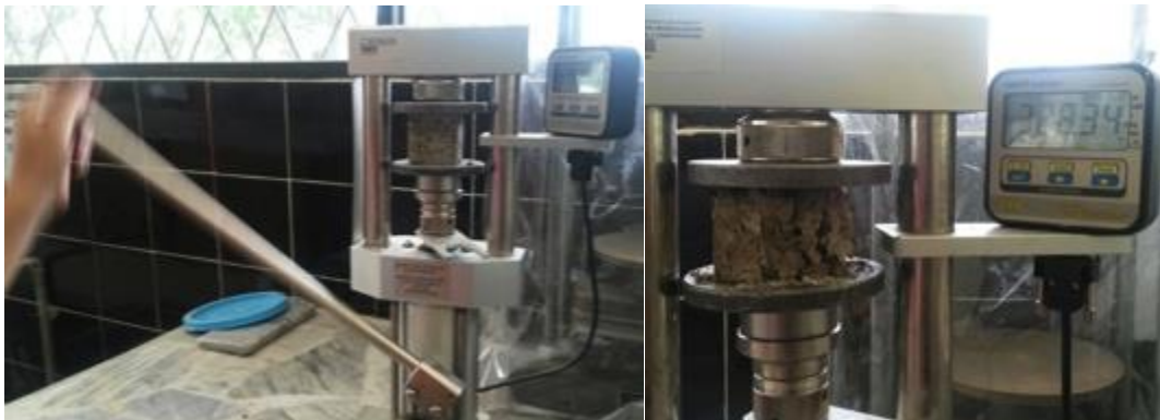
Figura 39. Máquina usada para pruebas de resistencia a la compresión mortero.
