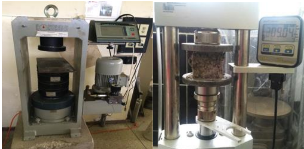
Figura 55. Equipo para pruebas de resistencia a la compresión.
