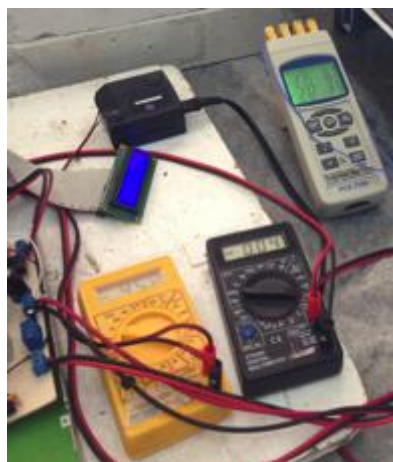
Figura 42. Sistema de calentamiento, termómetro, amperímetro y voltímetro.
