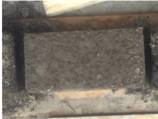
Figura 20. Cuarto modelo desencofrado y en proceso de curado.
