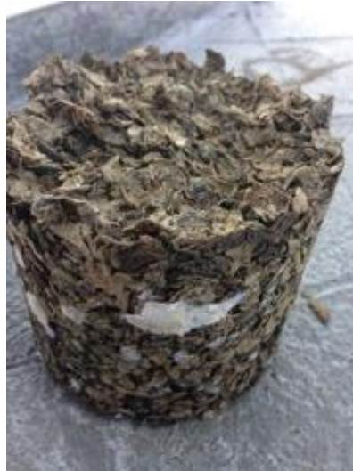
Figura 14. Desencofrado después de proceso de curado en seco.
