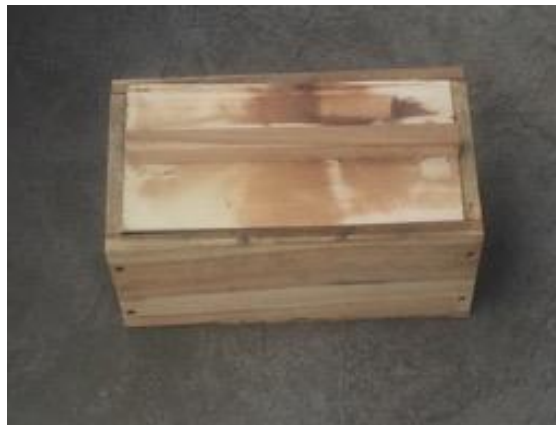
Figura 10. Molde rectangular con tapa para compresión.
