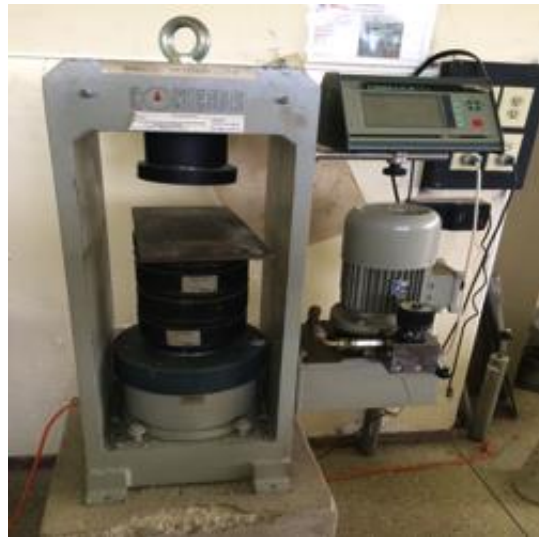
Figura 38. Máquina usada para pruebas de resistencia a la compresión.
