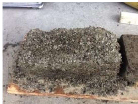
Figura 22. Quinto modelo en proceso de curado vista lateral.
