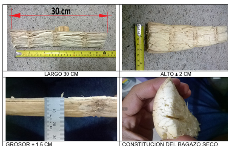
Figura 23. Medidas del bagazo de caña para ensayo P01
