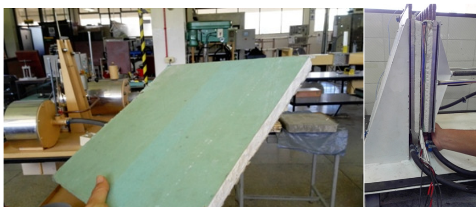
Figura 51. Instalación del material de prueba en el equipo
