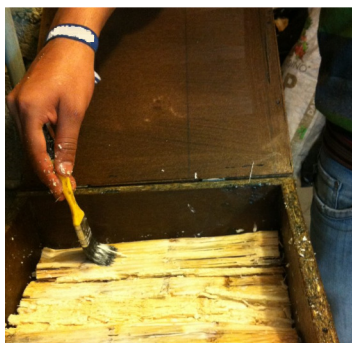
Figura 25. Proceso de fabricación del panel aislante para ensayo P01
