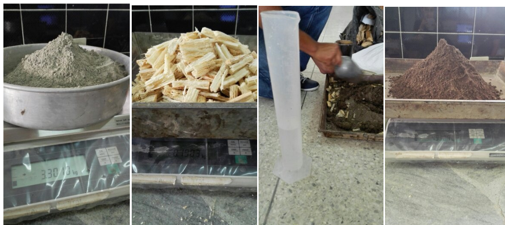
Figura 59. Peso de ingredientes para probeta de biomasa
