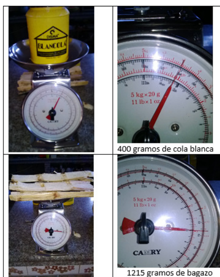
Figura 24. Medidas del peso de los elementos para ensayo P01
