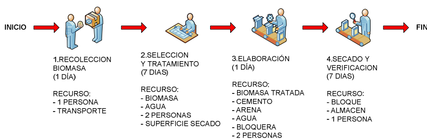
Figura 80. Proceso de fabricación de bloques de bagazo de caña
