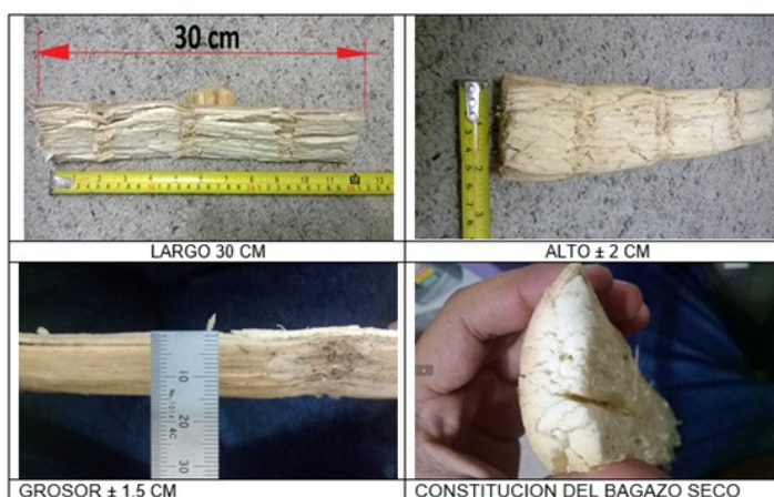
Figura 33. Dimensiones de bagazo para ensayo P05
