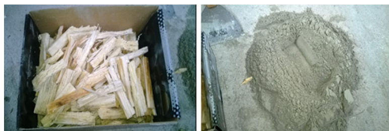
Figura 17. Elementos que conforman el bloque de cemento
