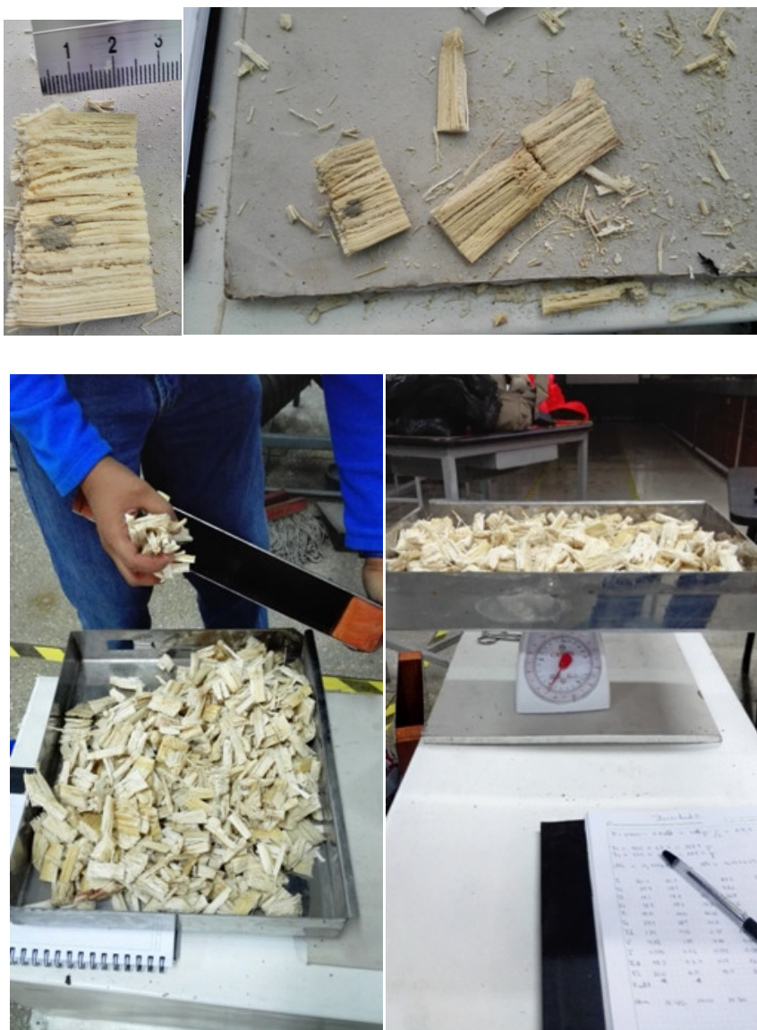
Figura 55. Pruebas de biomasa en trozos
