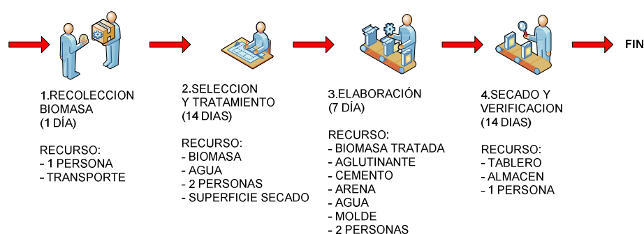
Figura 82. Proceso de fabricación de tablero de bagazo de caña
