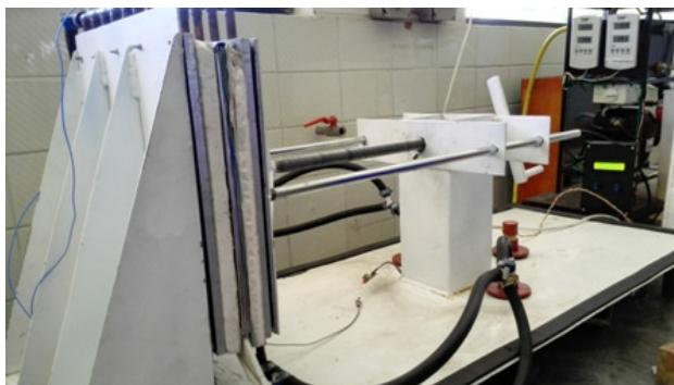
Figura 44. Máquina de medición de coeficiente térmico
