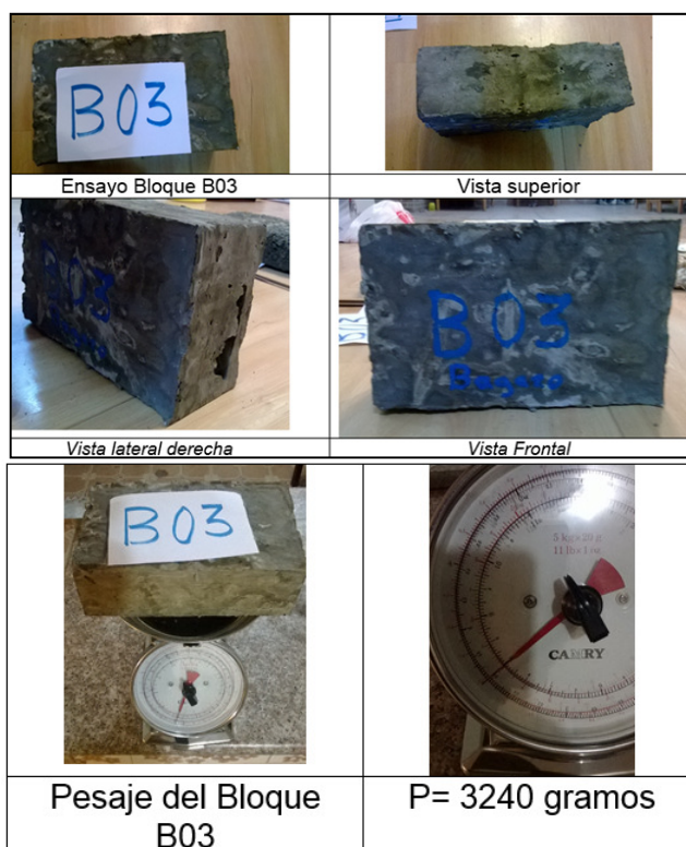
Figura 18. Fotografías finales del bloque de cemento
