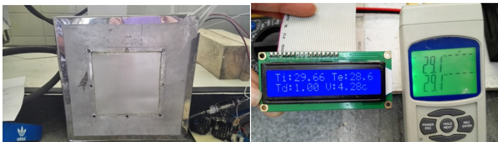
Figura 50. Comprobación de temperaturas en placa caliente
