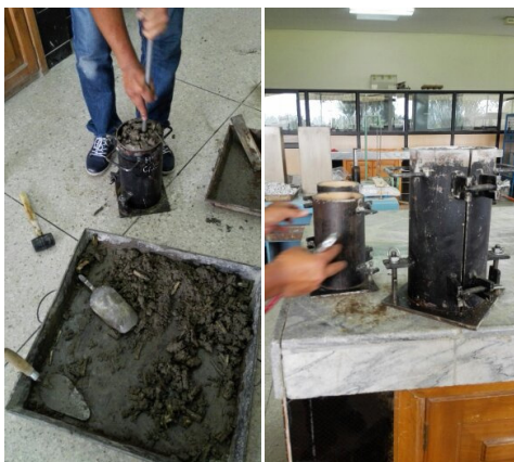
Figura 62. Compactación de probetas
