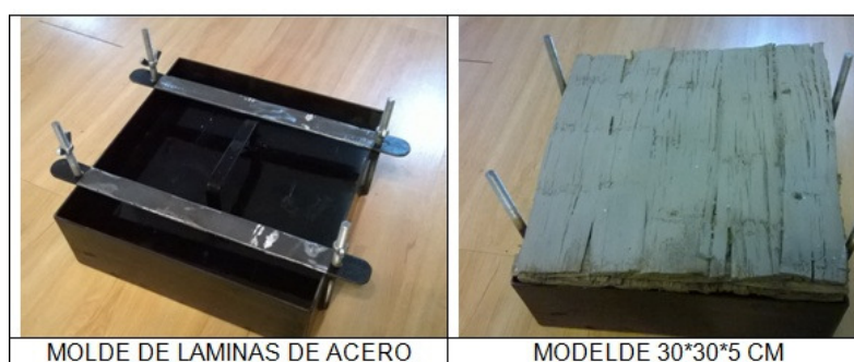
Figura 36. Molde de metal y producto final de ensayo P05
