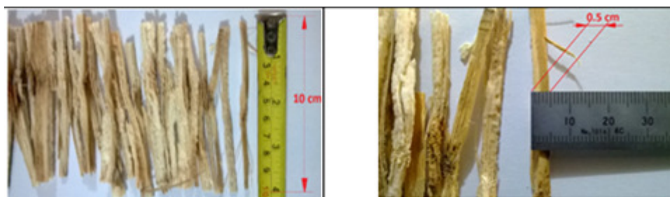
Figura 15. Medidas de la fibra de bagazo seleccionada
