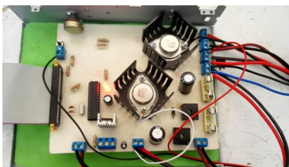
Figura 43. Tarjeta de control de sistema de placa caliente
