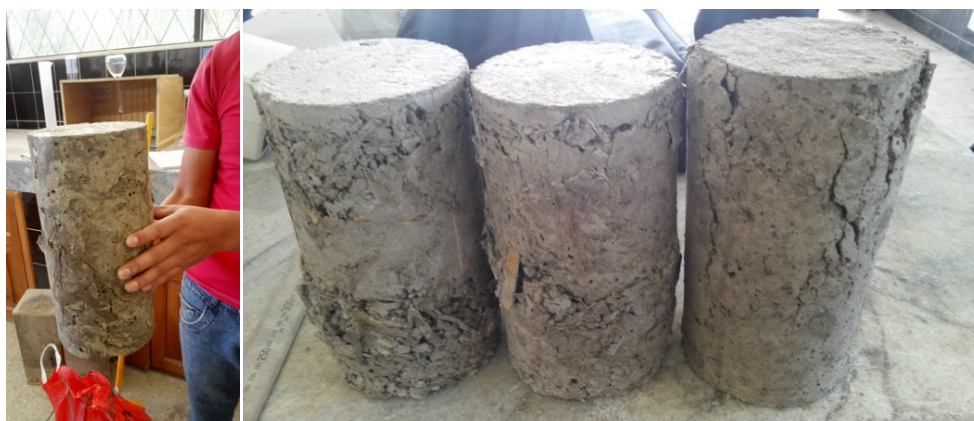
Figura 63. Desmolde de probetas
