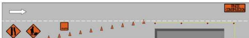
**Figura 74. Emplazamiento tipo de señales y dispositivos de seguridad: Vía de circulación y dos carriles**
