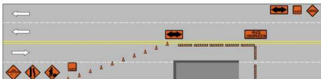
**Figura 75. Emplazamiento tipo de señales y dispositivos de seguridad: Interrupción de dos carriles**
