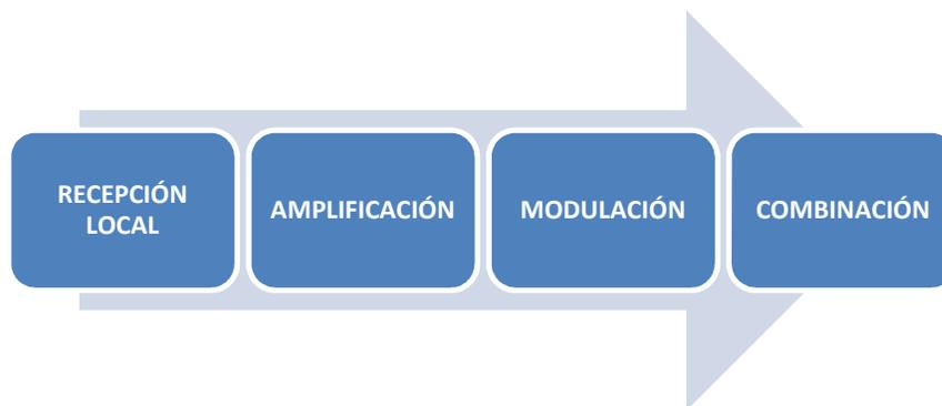
Gráfico N° 40: Diagrama de bloques del procesamiento de señales de televisión abierta local.
