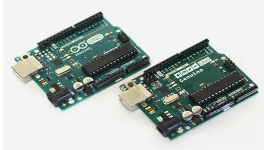
**Figura N° 20: Arduino Uno.**
