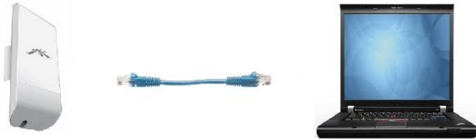
**Figura N° 50: Conexión antena Station con el cliente de la red.**
