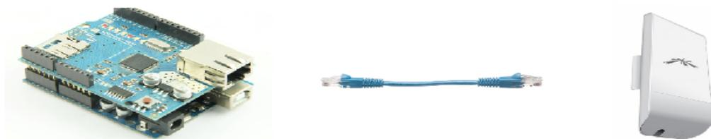
**Figura N° 49: Conexión servidor de la red con la antena Access Point**
