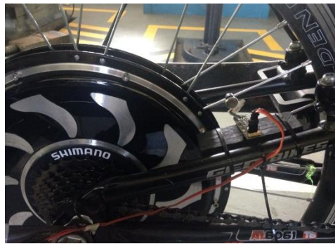
Figura No. 66. Sensor de Velocidad Instalado en la Tricicleta
