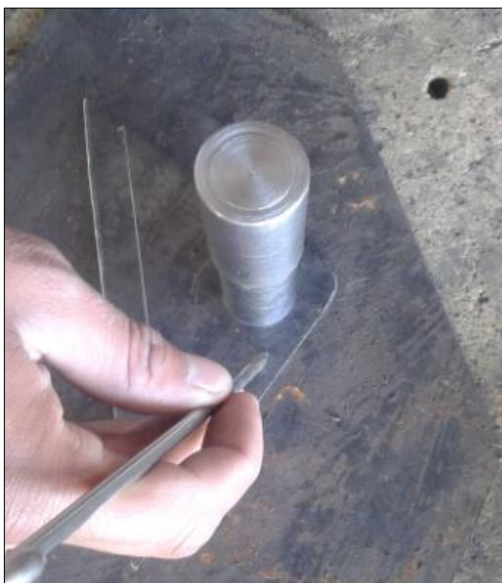
Figura 70.- Toma de bocetos para las perforaciones.
