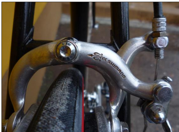
Figura 11.- Caliper de Tiro Lateral de Pivote Sencillo
