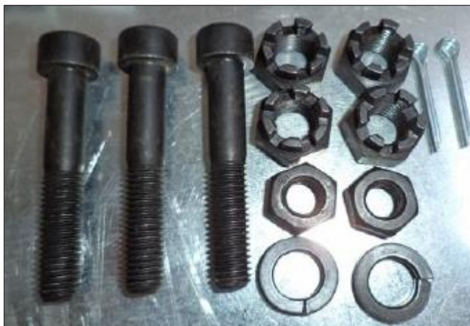
Figura 74.- Elementos de sujeción SAE grado 8
