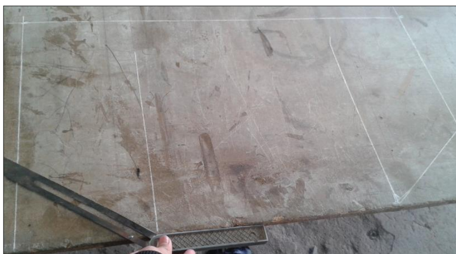
Figura 63.- Elaboración del croquis para el doblado del manubrio
