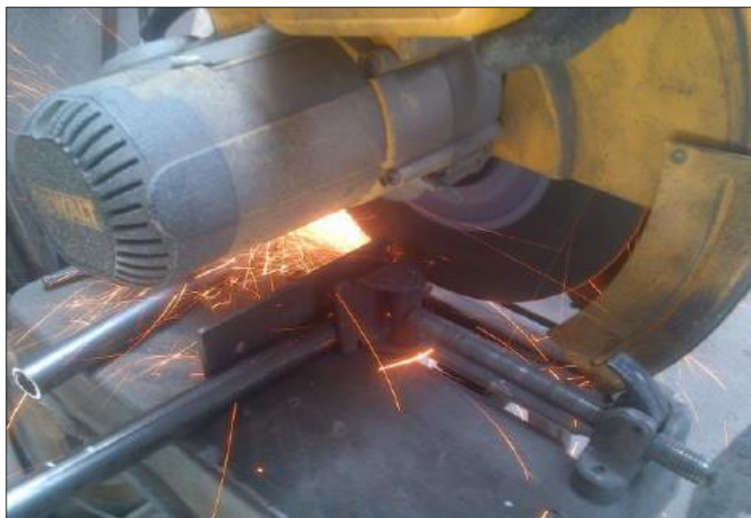
Figura 62.- Corte de tubo ASTM A-36
