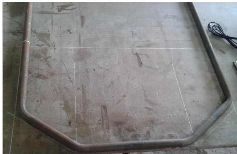
Figura 65.- Verificación de las medidas del manubrio con el croquis
