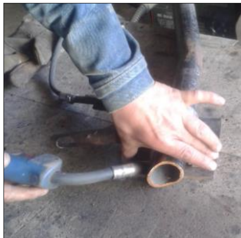
Figura 68.- Soldadura de la abrazadera (Proceso GMAW)
