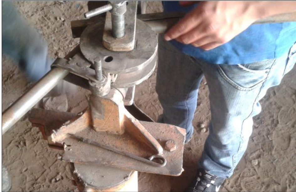
Figura 64.- Doblado del tubo para el manubrio
