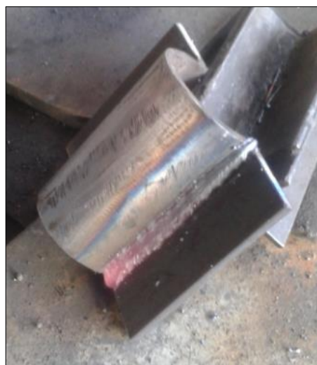
Figura 69.- Cordón de soldadura de la abrazadera
