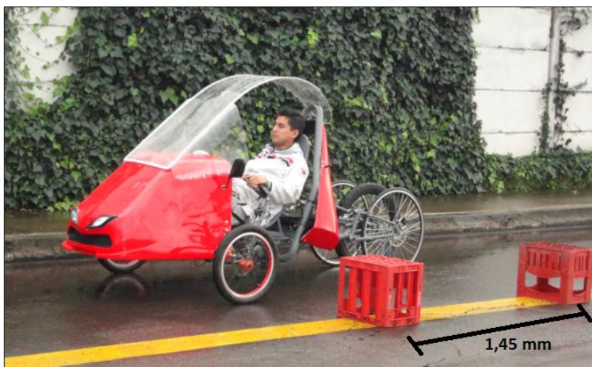
Figura 79.- Pruebas de distancia de frenado
