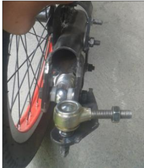
Figura 73.- Posición de las rótulas en la placa
