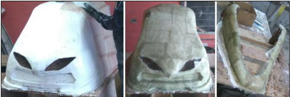
Figura 104.- Aplicación de fibra de vidrio al molde base
