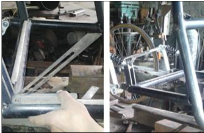
Figura 94.- Suelda de las barras de protección posterior y lateral
