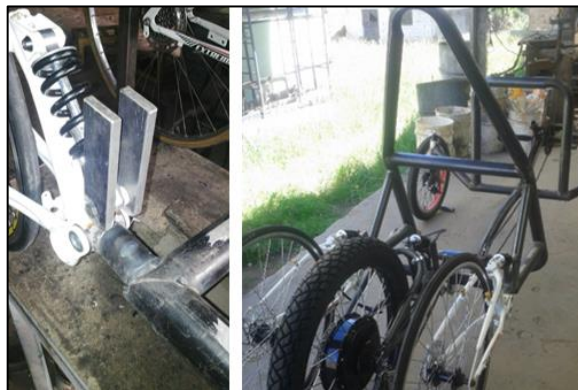
Figura 96.- Suelda de la barra de fijación de las ruedas posteriores
