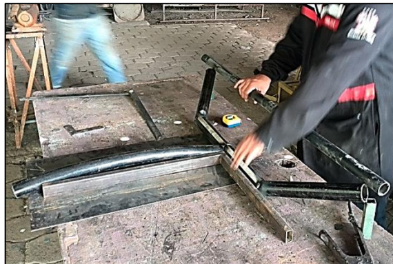
Figura 92.- Suelda de la viga central
