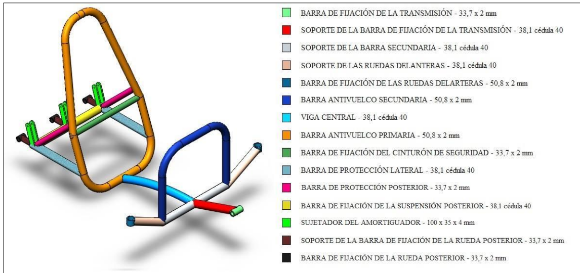
Figura 88.- Barras estructurales del prototipo
