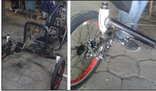
Figura 95.- Suelda de la barra de fijación de las ruedas delanteras
