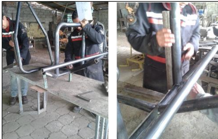
Figura 93.- Fijación de las barras antivuelco
