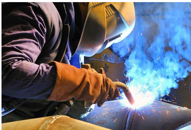
Figura 25.- Proceso de soldadura MIG
