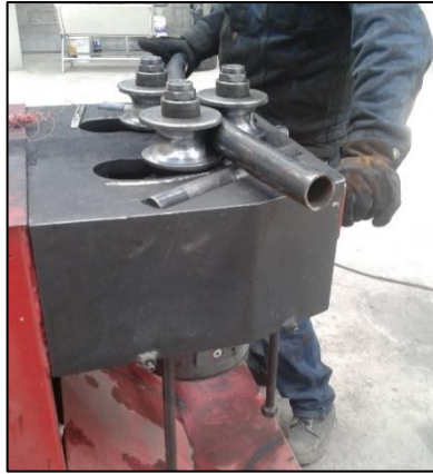
Figura 91.- Barolado de la viga central
