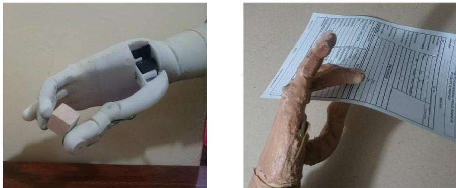
**Figura 115 Prueba de Agarre de precisión en trípode**
