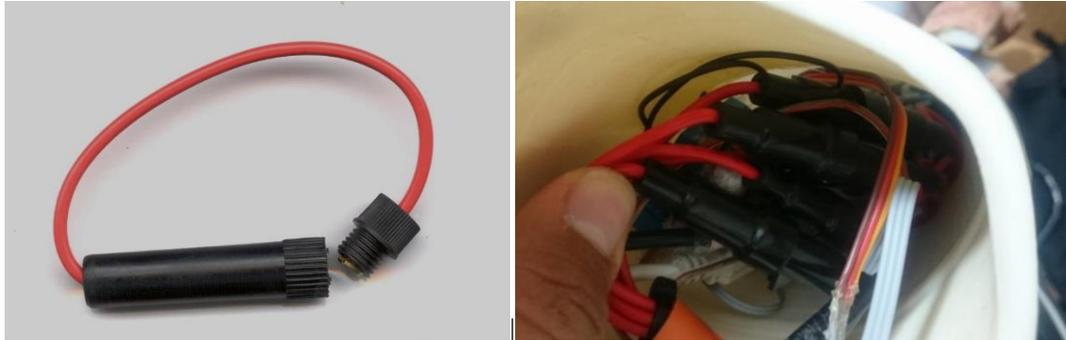
**Figura 90 Fusibles para los servomotores**
