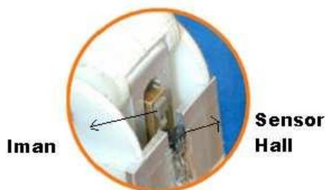
**Figura 19 Sensores de efecto Hall en la mano Cyberhand**
