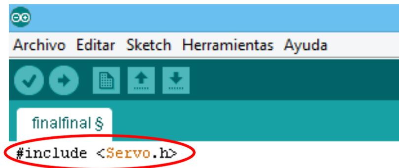
**Figura 99 Librería para el manejo de servomotores.**
