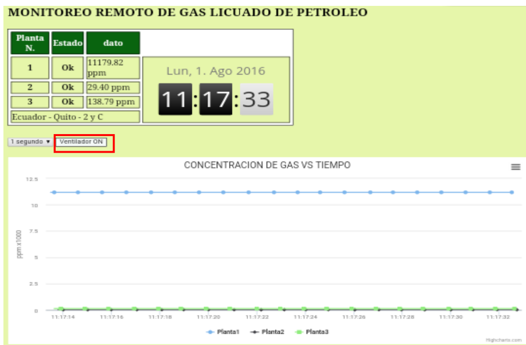
Figura 93 Señal de concentración de gas de Planta 1
