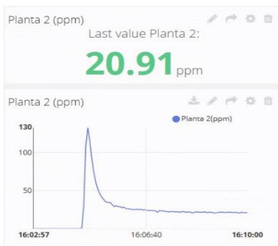
Figura 81 Señal estable del sensor 2
