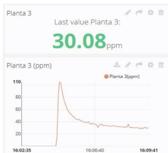
Figura 82 Señal estable del sensor 3
