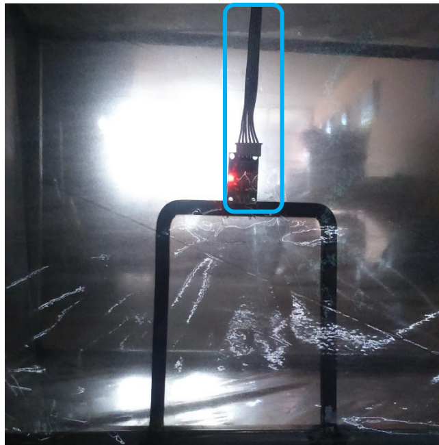
Figura 37 Cableado del sensor
